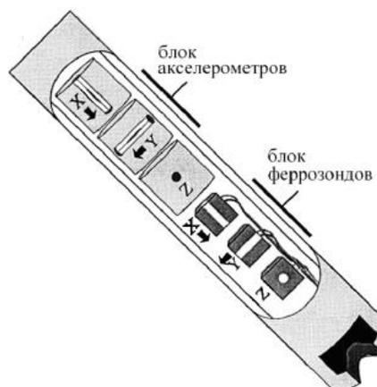
Рисунок 6 – Блок чувствительных элементов забойного инклинометра
