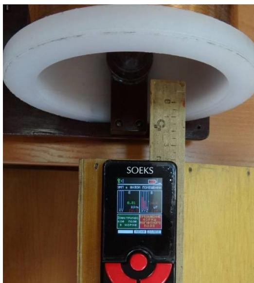
Рисунок 29 – Магнитометр SOEKS
