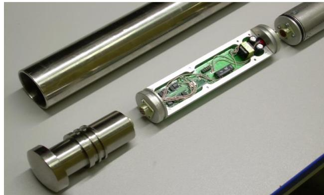
Рисунок 3 – Электронный блок инклинометрического модуля
