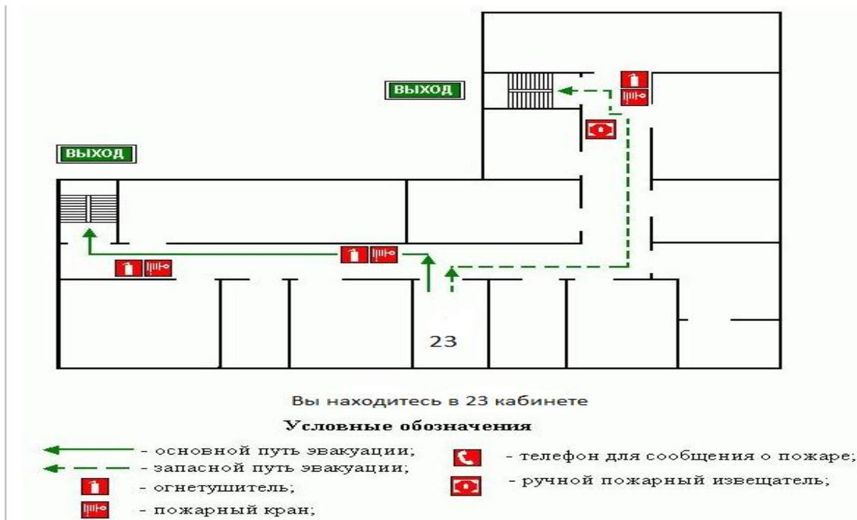
Рисунок 6-14- План эвакуации при пожаре и чрезвычайных ситуациях.
