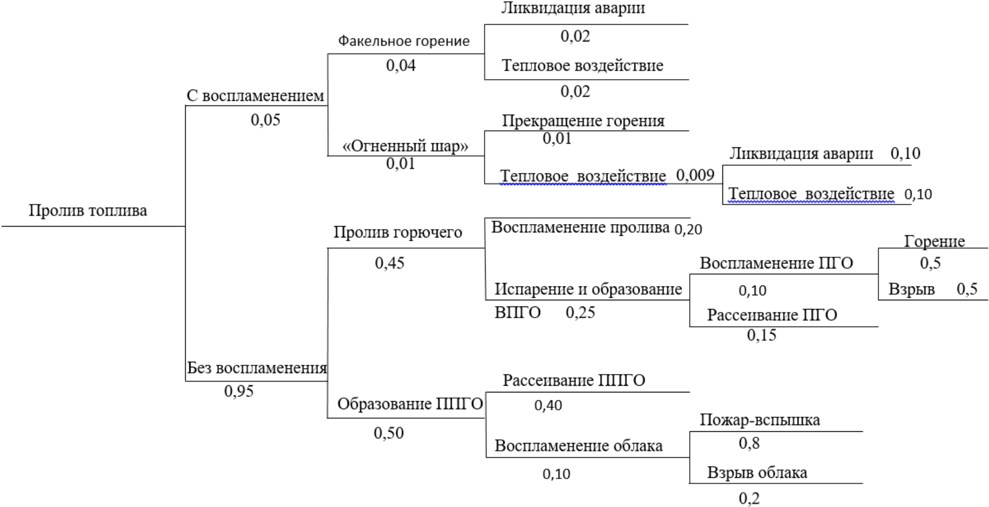
Рисунок Е.1– Дерево событий при разгерметизации резервуара
