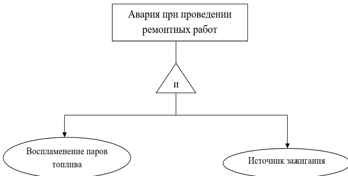
Рисунок 4 –Дерево отказов при проведении ремонтных работ
