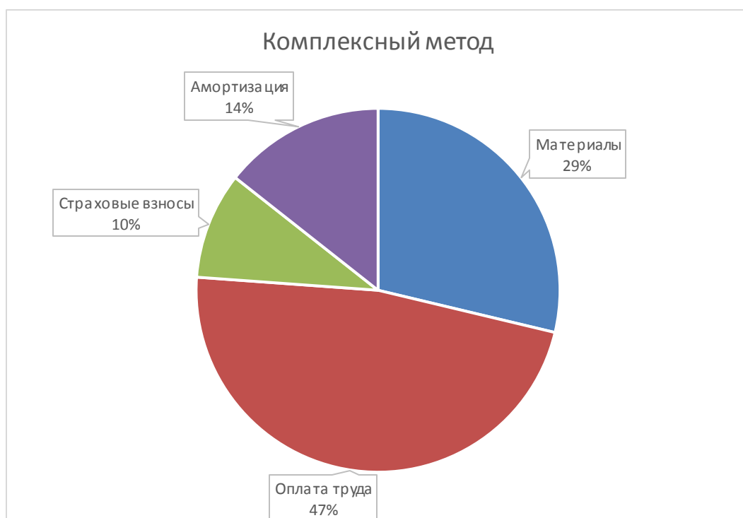
Рис.2 Структуры затрат на выполнение работ комплексным методом
