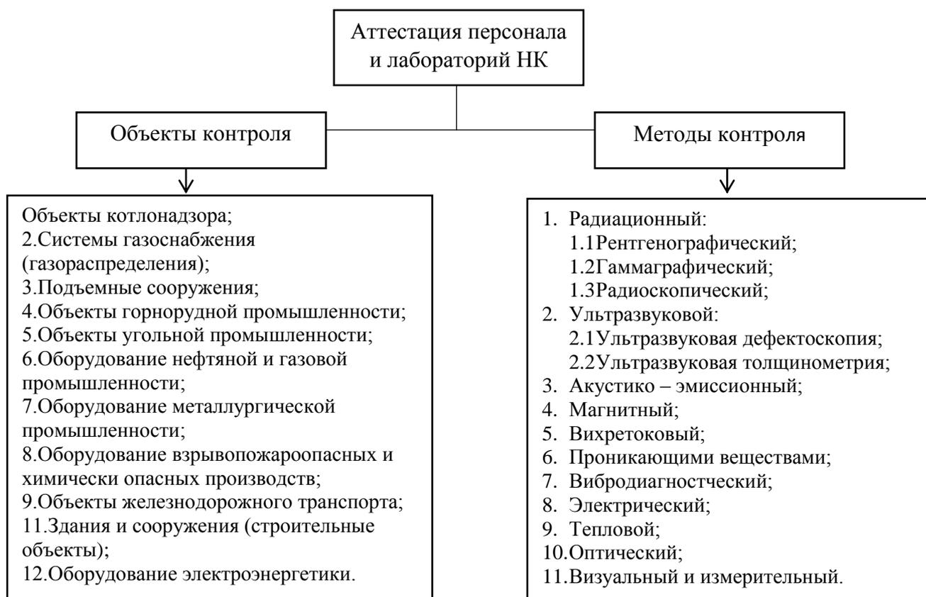
Рисунок 6 - Объекты и методы неразрушающего контроля
