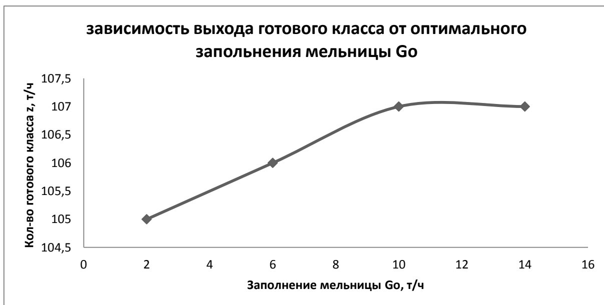
Рисунок 17 – Зависимость выхода готового класса от оптимальное заполнение мельницы
