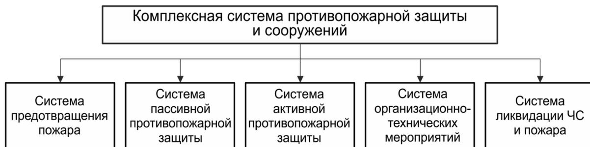
Рисунок 7- Комплексная система противопожарной защиты зданий
