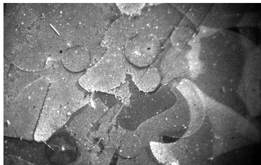
Рис. 5. Фотография пленки серы, сформированной на поверхности предметного стекла, помещенного в реактор
