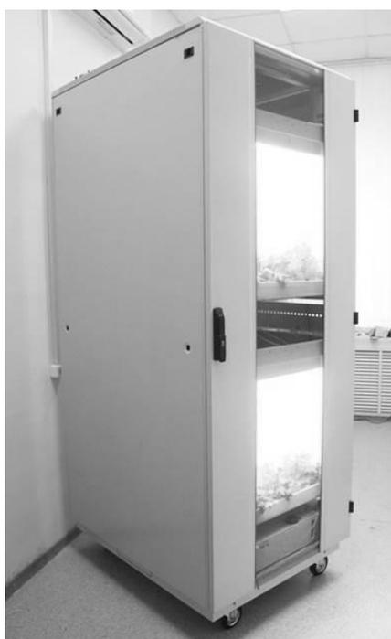
Рис. 20. Внешний вид исследовательского фитотрона
