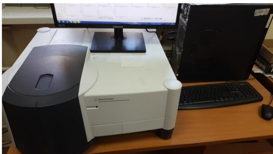
Рисунок 3.6.1. Спектрофлуориметр Agilent Cary Eclipse
