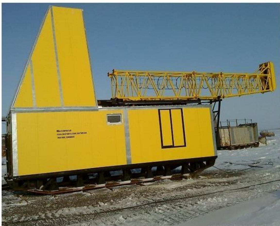
Рисунок 7 – Буровая установка ПБУ 1200
