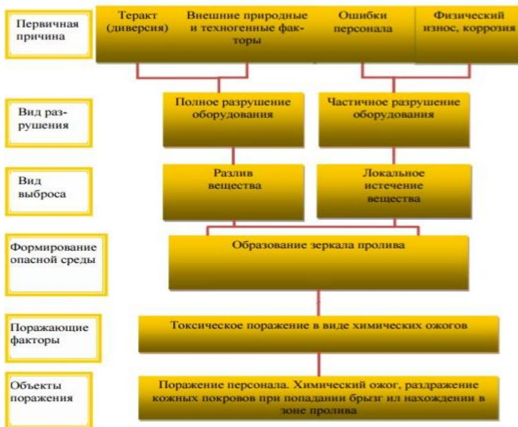
Рисунок 3.6 – Схема построения сценариев развития аварий на объекте с оборудованием содержащим едкий натрий
