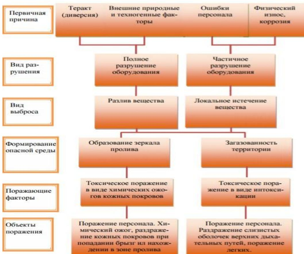
Рисунок 3.3 – Схема построения сценариев развития аварий на объекте с оборудованием, содержащим серную кислоту
