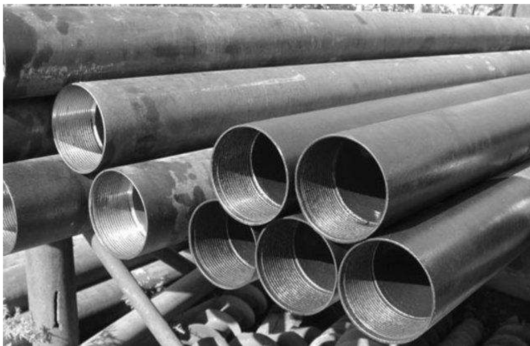
Рисунок 4.7 - Обсадные трубы d-127
