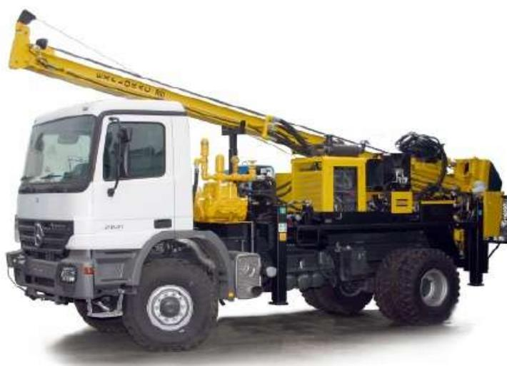
Рисунок 2.4 – Самоходная установка Explorac R50
