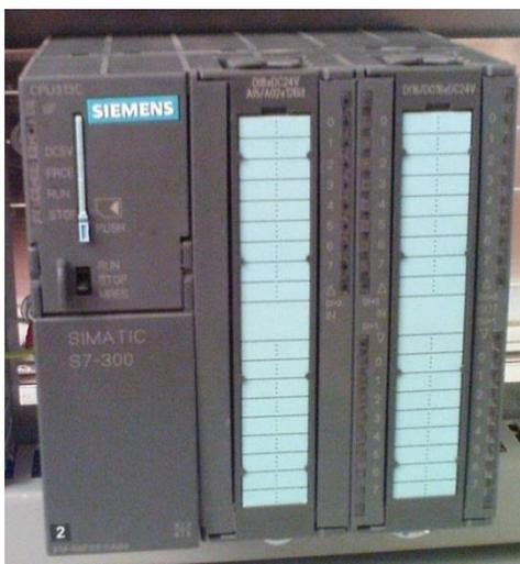
Рисунок 3 – Внешний вид контроллера Siemens SIMATIC S7-300
