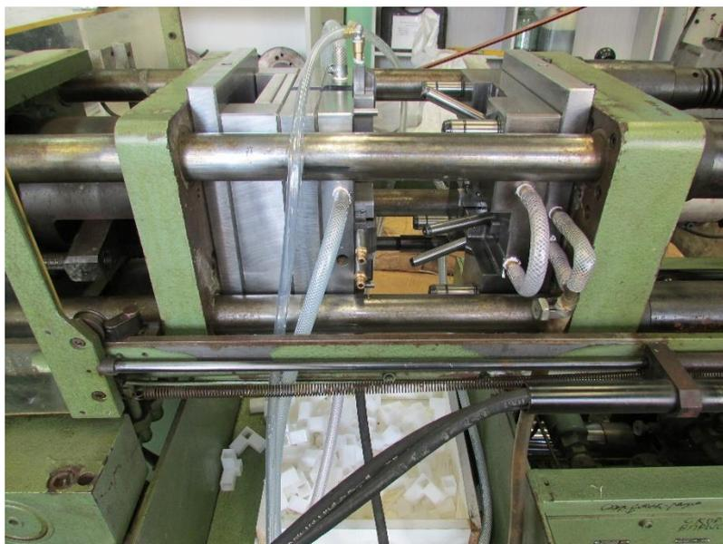
*Рис. 4.2. Установка системы охлаждения пресс-формы*
