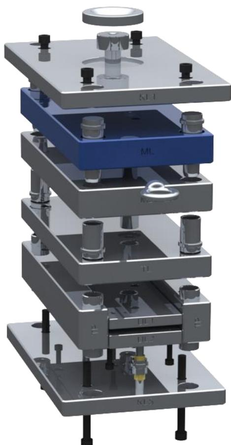
*Рисунок 2.3.2.1. Общая 3D схема пресс-формы*
