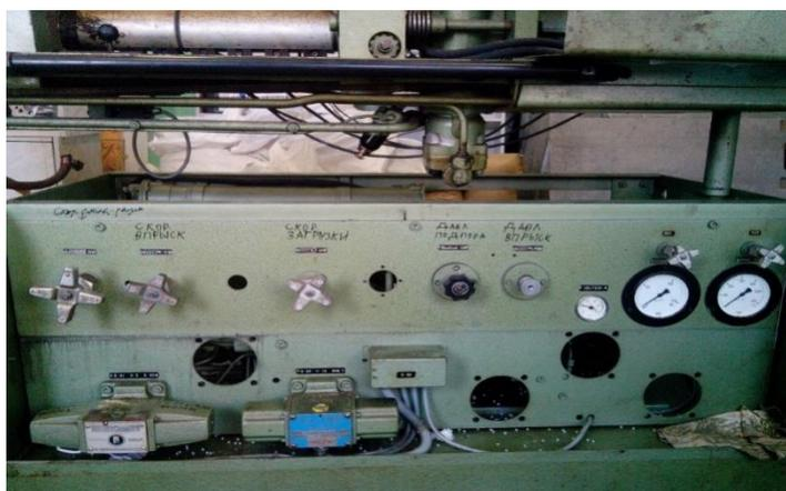
*Рис. 4.4. Панель настройки режимов термопластавтомата*
