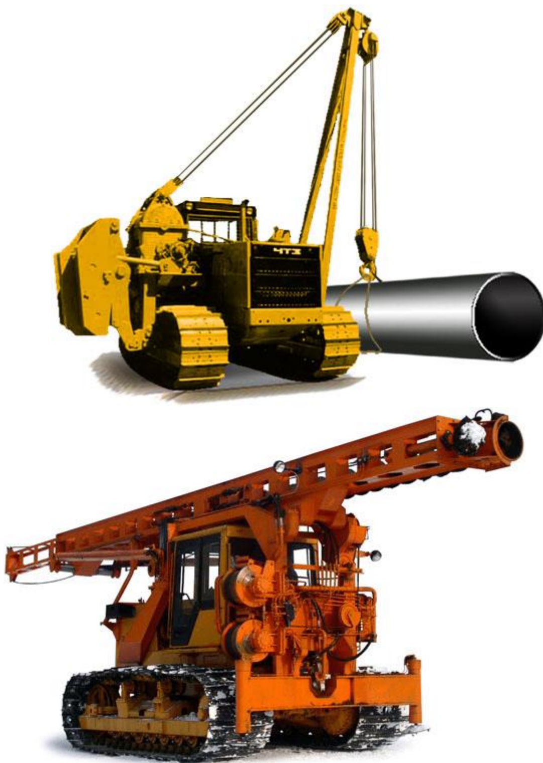
Рисунок 5 – трубоукладчик и бурильно-сваебойная машина
