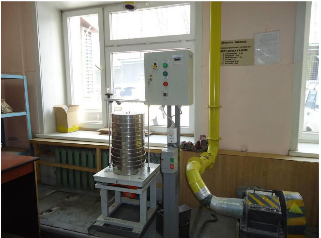
Рис. 3.3. Комплект сит для гранулометрического исследования грунта
