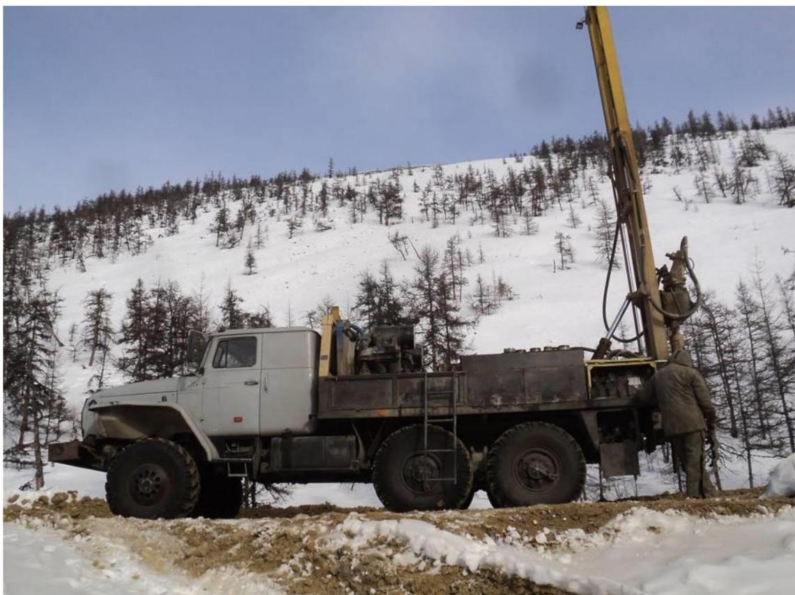
Рис. 3.1 Буровая установка УРБ-2А.
