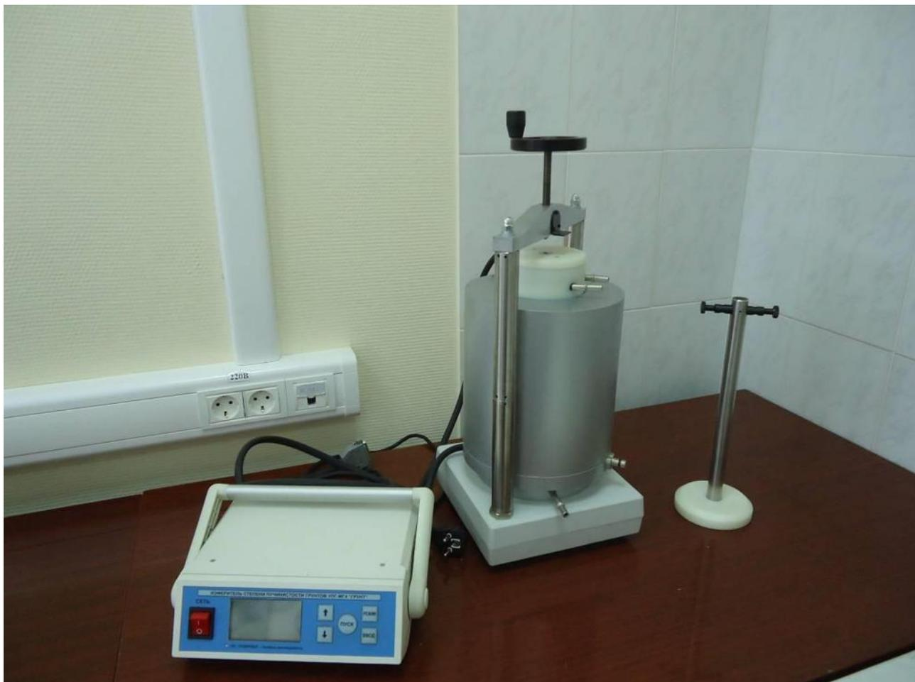
Рис. 3.4 Измеритель морозной пучинистости грунта УПГ-МГ4 «Грунт»
