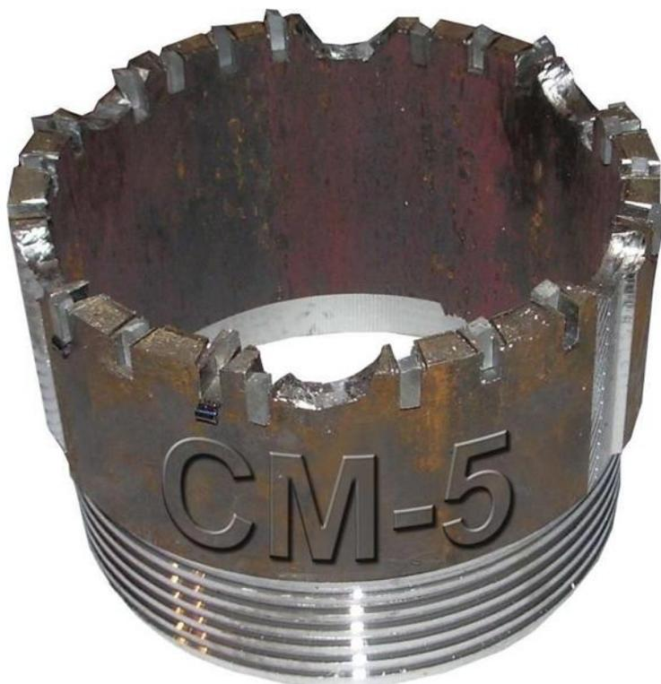
Рис. 3.2 Твердосплавные коронки типа CM-5.
