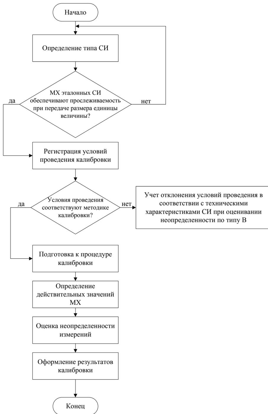
Рисунок 10 – Алгоритм проведения калибровки
