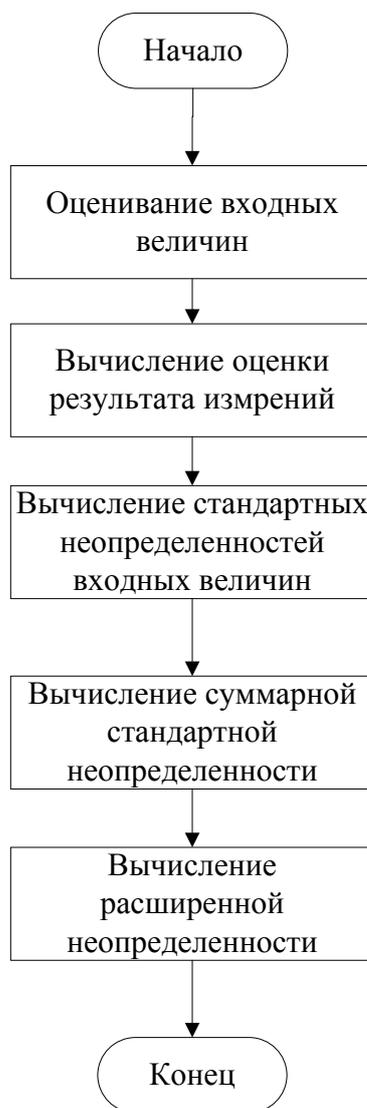
Рисунок 12 – Алгоритм проведения оценки неопределенности измерений
