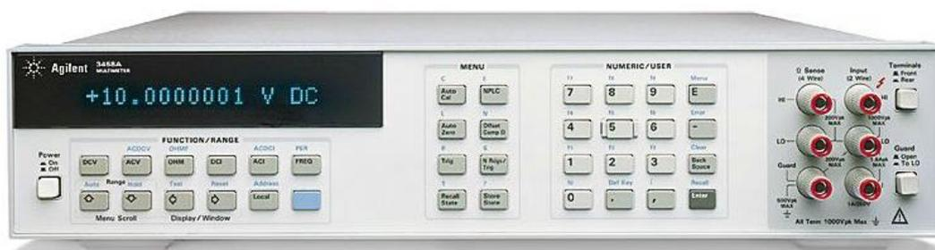
Рисунок 3 – Мультиметр 3458А
