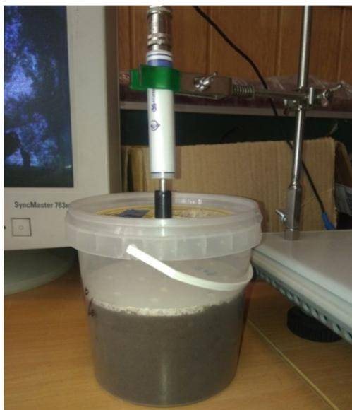
Рисунок 5 – Электронный цифровой датчик влажности
