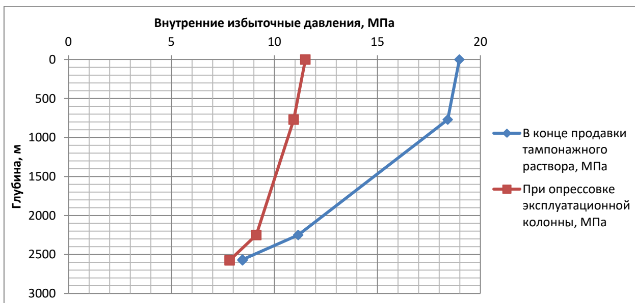
Рисунок 10 – Эпюра внутренних избыточных давлений
