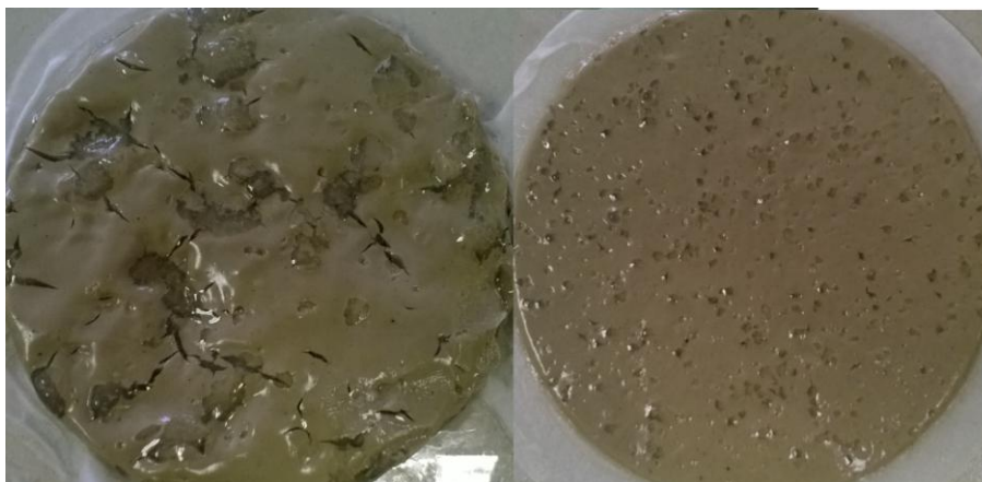
Рисунок 15 – Фотографии фильтрационных корок. Слева – сухой ввод «Образца 1», справа – суспензионный, время перемешивания 5 минут
