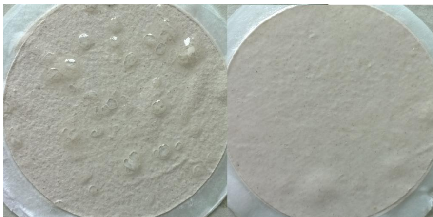
Рисунок 19 – Фотографии фильтрационных корок. Слева – сухой ввод «Образца 1», справа – суспензионный, время перемешивания 5 минут
