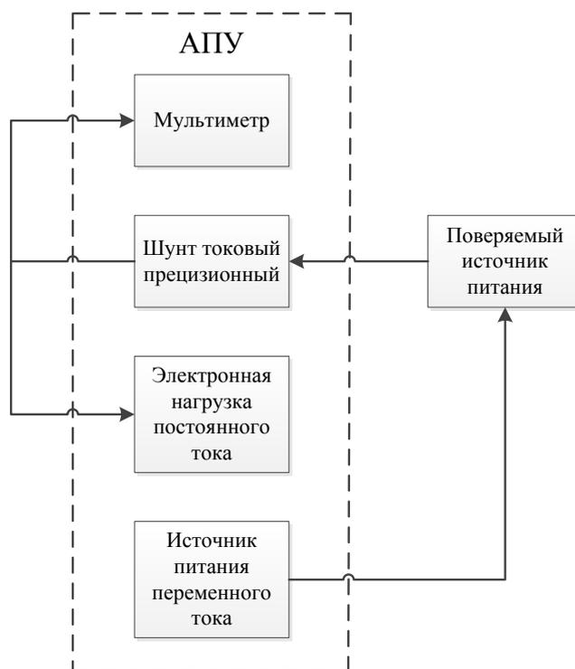
Рисунок 2.12 – Структурная схема для определения нестабильности силы постоянного тока на выходе при изменении напряжения на нагрузке и уровня пульсации силы постоянного тока на выходе
