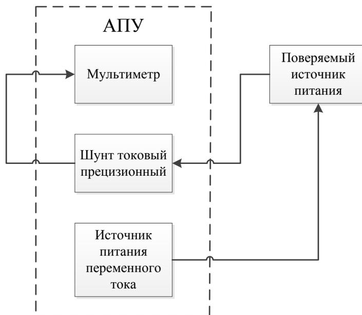
Рисунок 2.11 – Структурная схема для определения абсолютной погрешности установки силы постоянного тока и нестабильности силы постоянного тока на выходе при изменении напряжения электропитания источника
