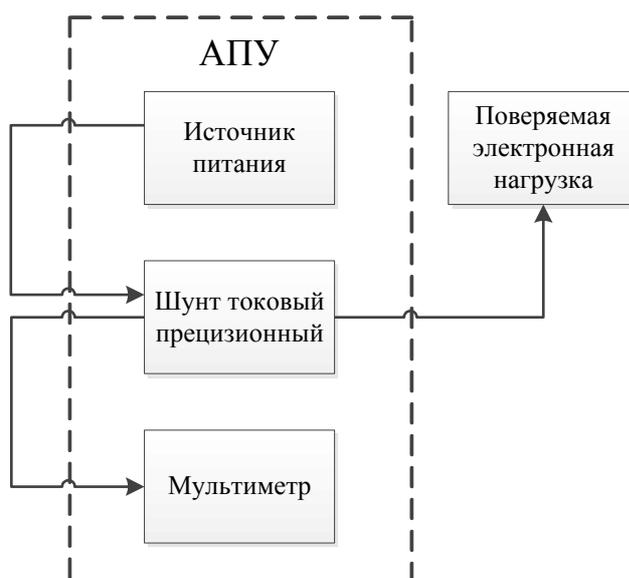
Рисунок 2.15 – Структурная схема для определения абсолютной погрешности установки и измерений мощности при работе в режиме стабилизации
