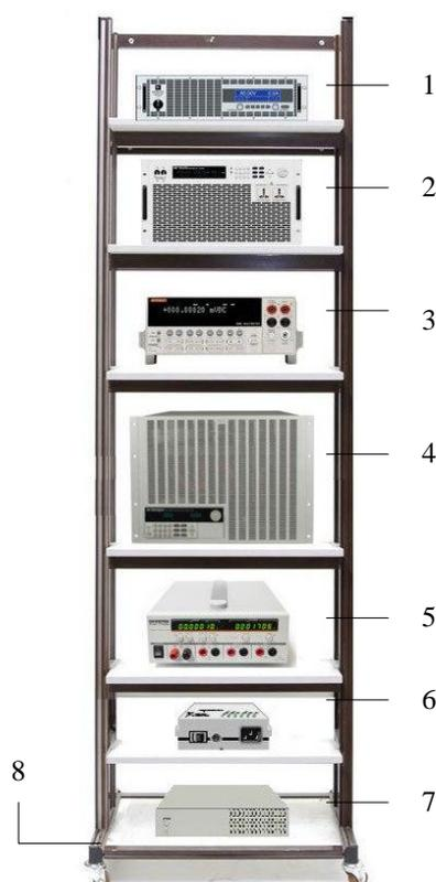
1 – источник питания EA-PS 9500-90 3U; 2 – источник питания АКПП 1202/4; 3 – мультиметр KEITHLEY 2002; 4 – электронная нагрузка ВК8526; 5 – шунт токовый PCS-71000; 6 – блок управления; 7 – блок коммутации; 8 – приборная стойка
