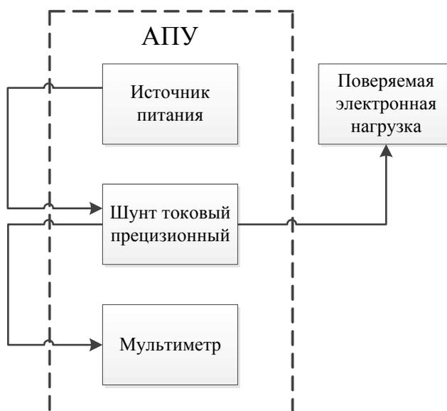
Рисунок 2.13 – Структурная схема для определения абсолютной погрешности установки и измерений силы постоянного тока при работе в режиме стабилизации силы постоянного тока
