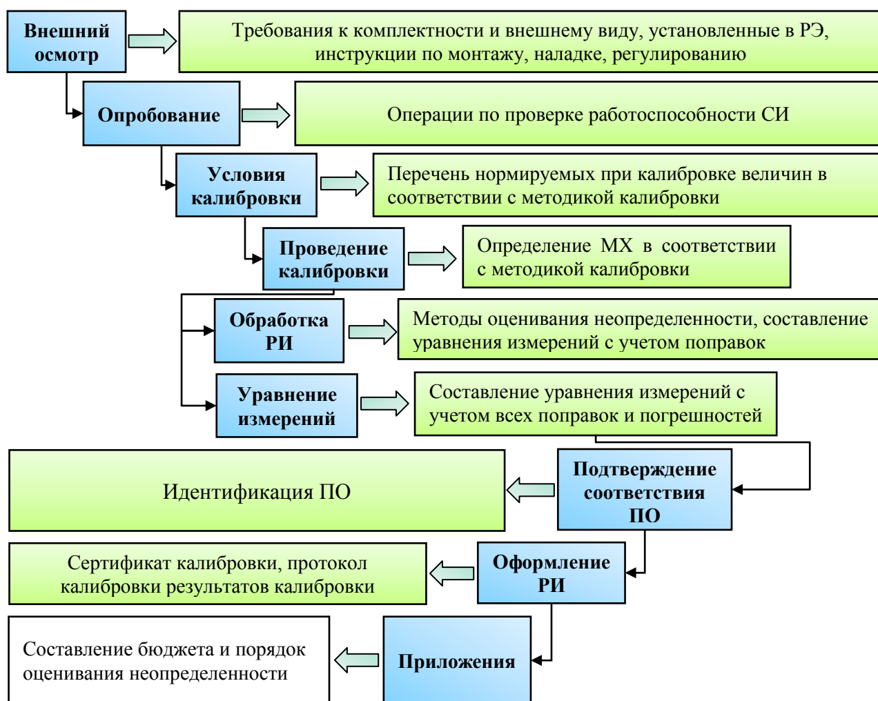
Рисунок 12 – Порядок проведения калибровки средств измерений
