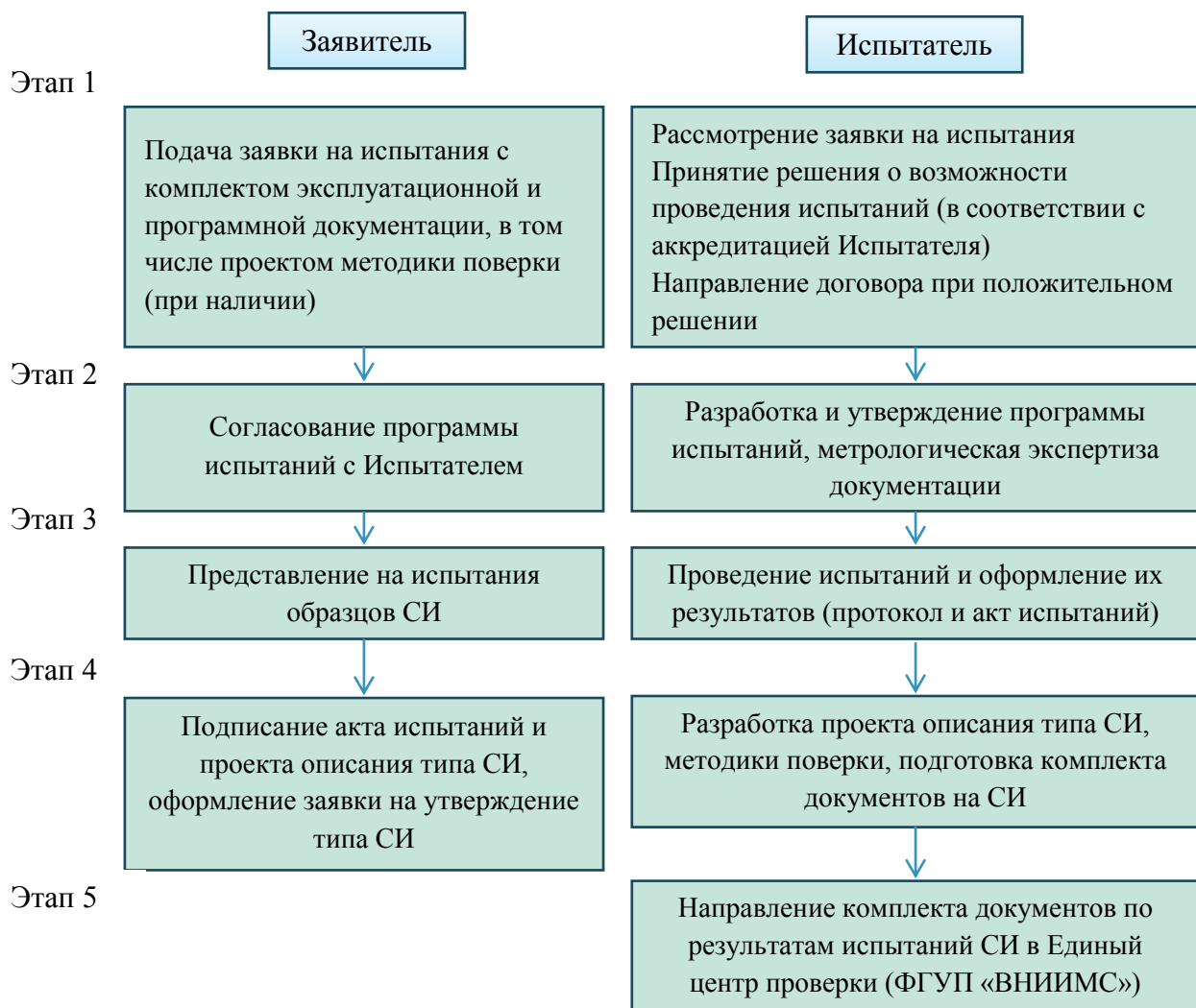
Рисунок 8 – Порядок проведения испытаний СИ в целях утверждения типа
