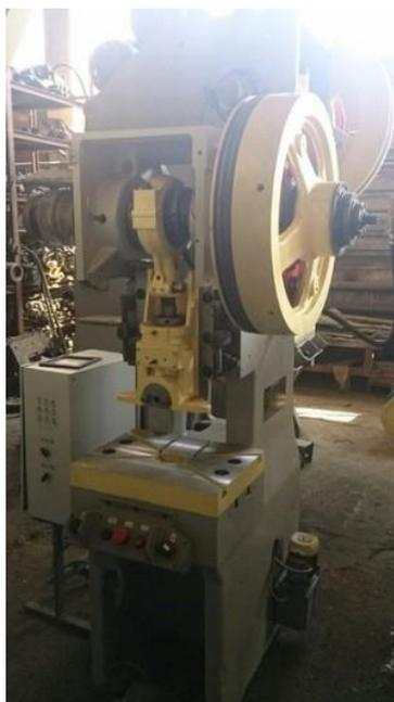
Рис.10 Пресс кривошипный КД 2122 усилием 16 тонн
