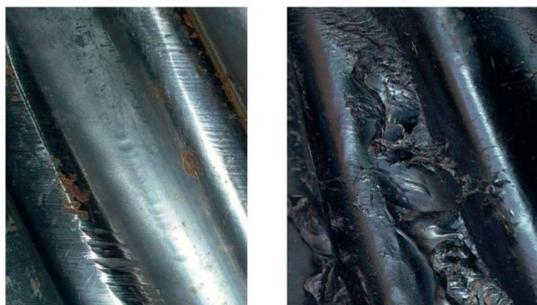
Рисунок 21-износ поверхностей ротора и статора винтового забойного двигателя
