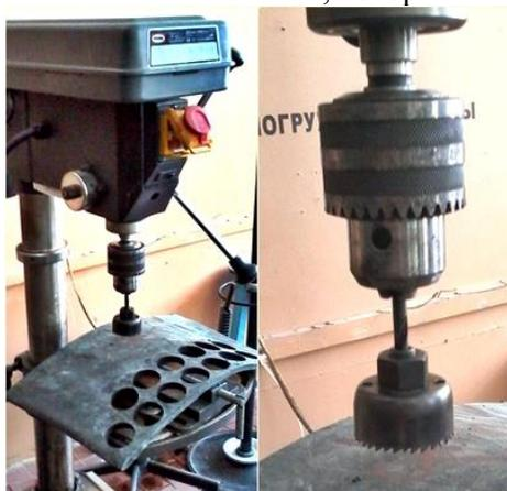
Рисунок 22 – Сверлильный станок и сверло для изготовления образцов
