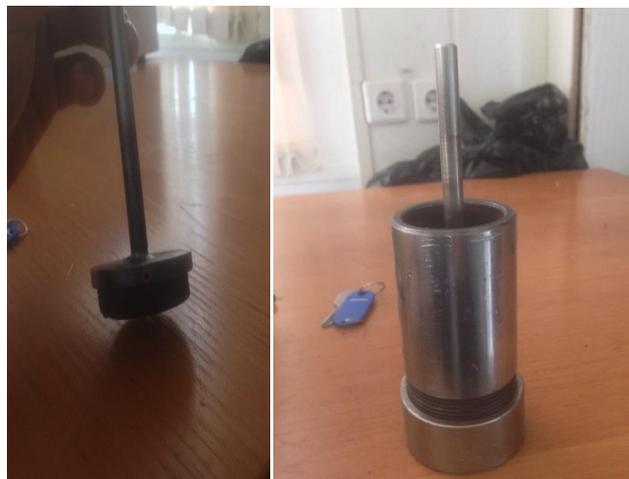
Рисунок 23 – Имитатор ротора и имитатор статора
