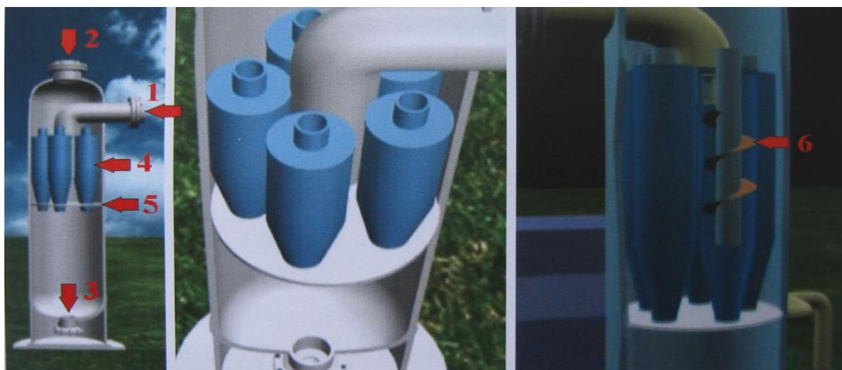
Рисунок 1.1 – Мультициклонный пылеуловитель с батареей циклонов (в разрезе).
