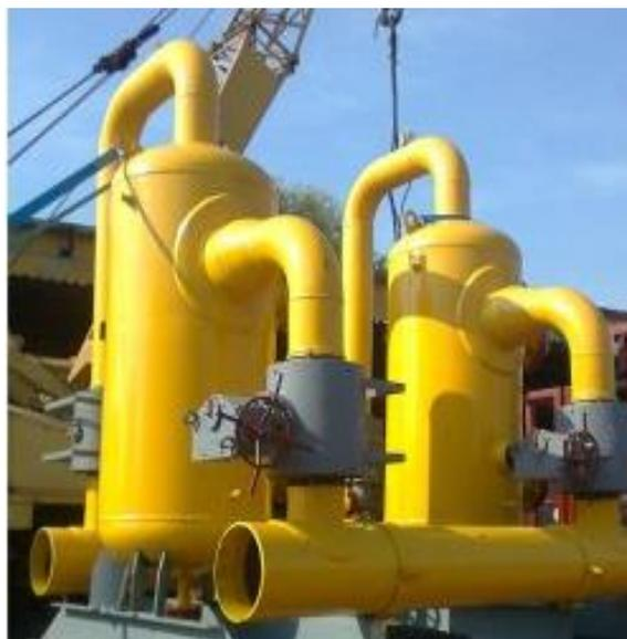
Принцип действия: газ через входной патрубок (сбоку) поступает в циклон, где, благодаря наличию винтовых лопастей, движется по спирали. Под действием центробежной силы твёрдые и жидкие частицы отбрасываются к периферии, затормаживаются о стенку циклона и выпадают на дно пылеуловителя. Очищенный газ выходит через выходной патрубок (сверху). Отвод жидкости и шлама (продувка пылеуловителя) осуществляется через продувочный патрубок (снизу) в промежуточную дренажную ёмкость.
