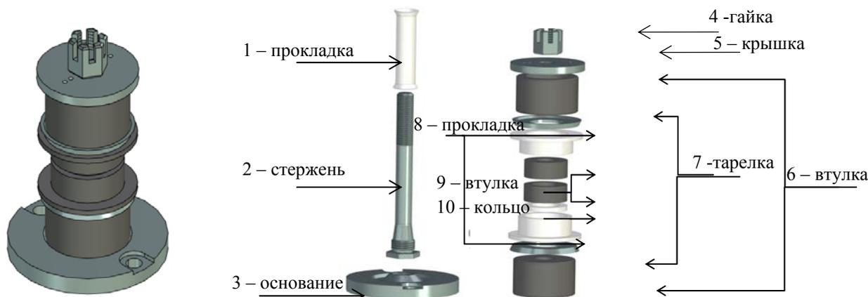
Рис. 1. 3D-модель амортизатора АРМОО-15
