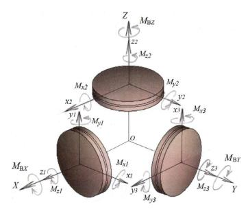
Рис. 3. Расположение ДМ для трехосного управления МКА
