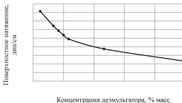
**Рис. 1.** Зависимость поверхностного натяжения от концентрации деэмульгатора
