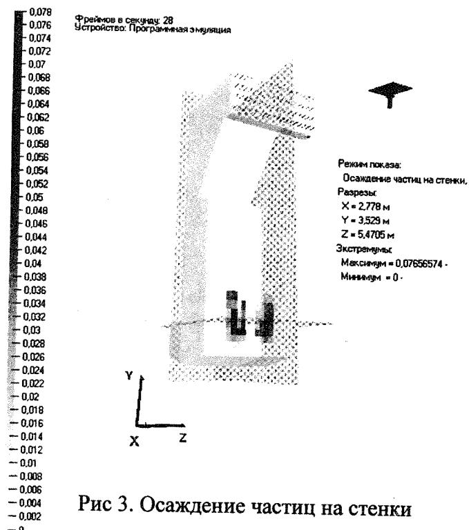
Рис 3. Осаждение частиц на стенки
