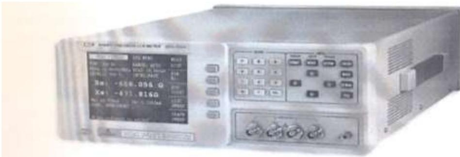
Рис.1 Измеритель добротности (или LCR-метр).
