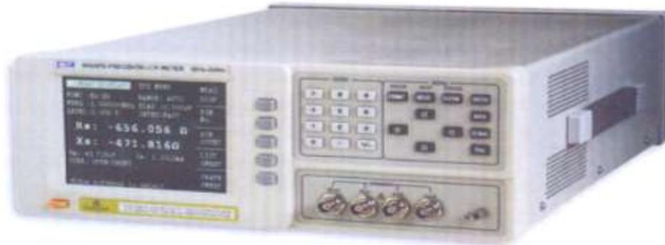
Рис.1 Измеритель добротности (или LCR-метр).
