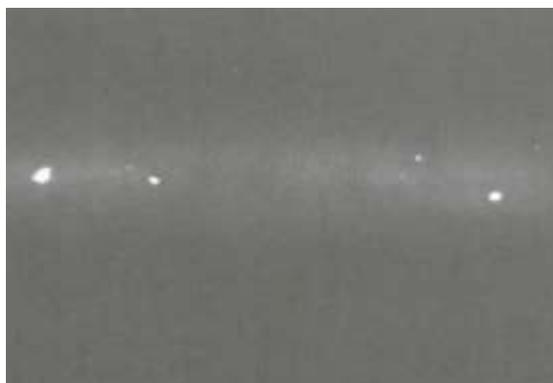
Рисунок 33 – Радиографическое представление вольфрамовых включений на рентгеновских снимках
