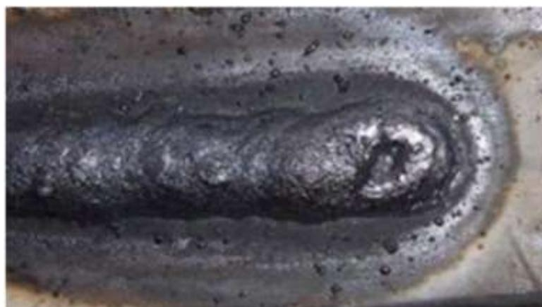
Рисунок 36 – Внешний вид сварного соединения с кратером
