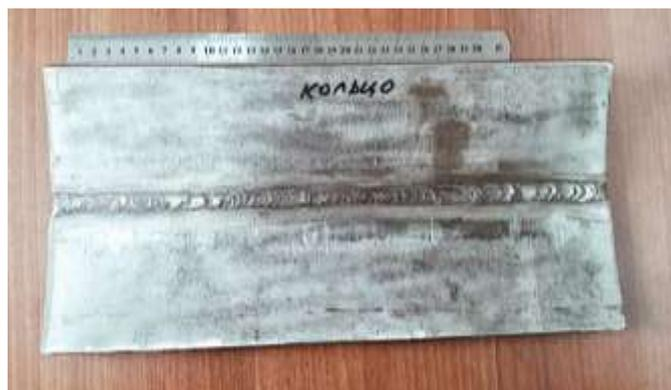
Рисунок 87 – Внешний вид образца кольца пенала
