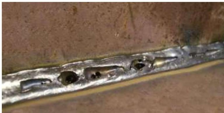
Рисунок 35 – Внешний вид сварного соединения со свищами
