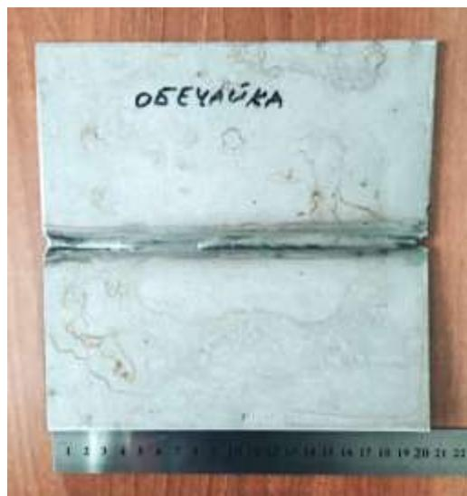
Рисунок 85 – Внешний вид образца обечайки пенала
