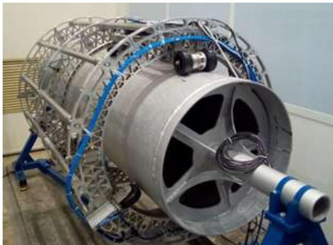
Рисунок 99 – Реализация автоматизированной системы ультразвуковой томографии модели пенала для хранения ОЯТ
