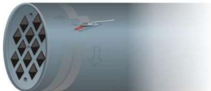
Рисунок 12 – Сканирование вставки с применением ФАР
