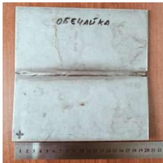
Рисунок 86 – Внешний вид образца второго типа обечайки пенала
