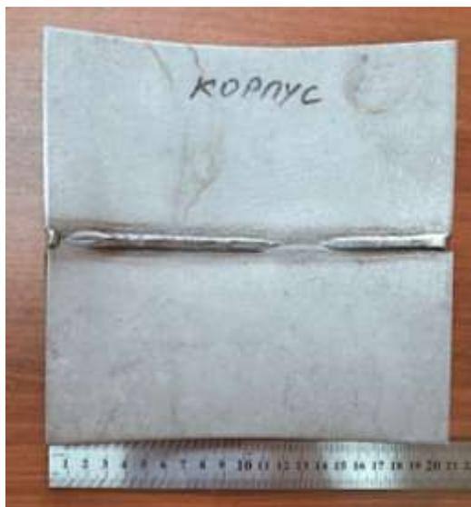
Рисунок 84 – Внешний вид образца корпуса пенала
