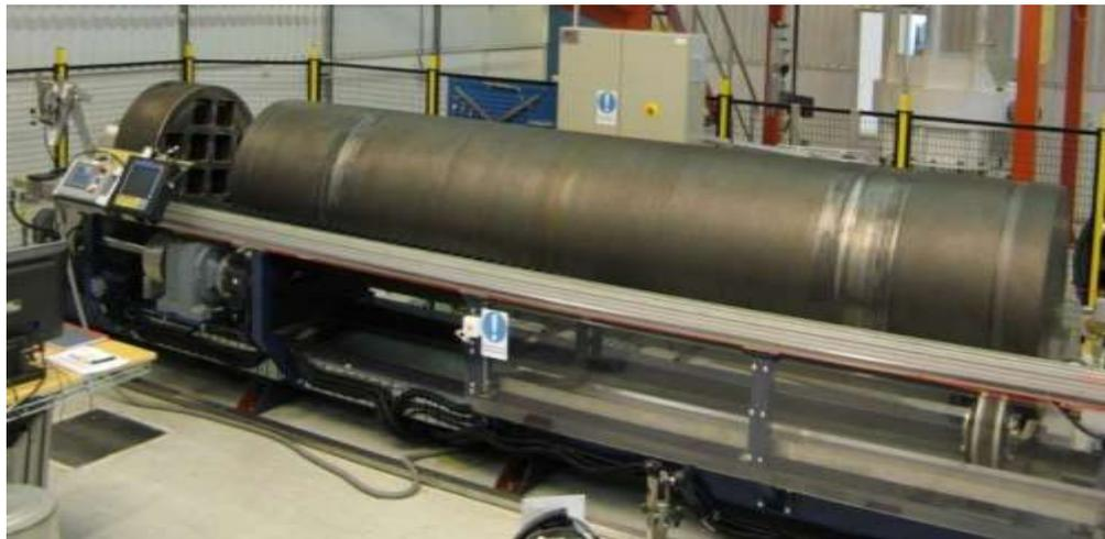
Рисунок 6 – Система УЗК медных труб и чугунных вставок
