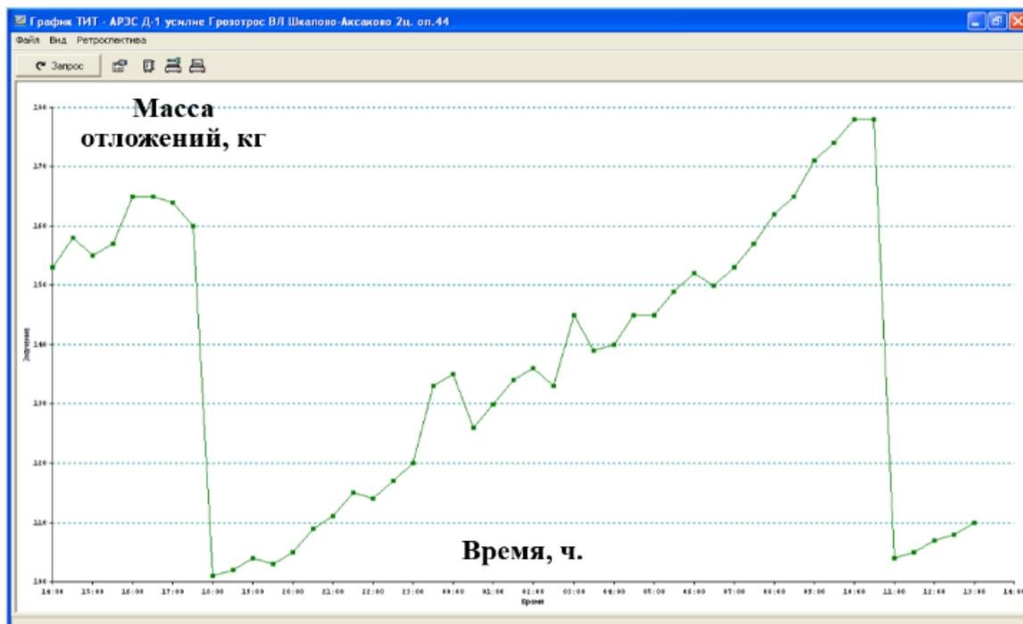
Рисунок 4.8 – Динамика нарастания гололеда и его плавка
