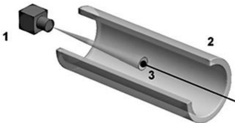
Рисунок 3.4.4.1. Схема эксперимента [156]: 1 – высокоскоростная видеокамера; 2 – трубчатая муфельная печь; 3 – капля топлива на держателе
