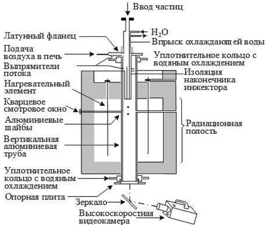
Рисунок 1.3.5. Схема экспериментального стенда для исследования зажигания и горения одиночных свободно падающих капель ВУТ [47]
