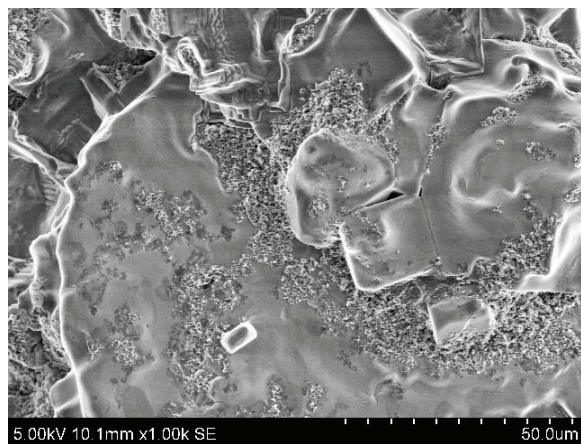
Рис. 1. Микрофотография поверхности гранулы хлорида калия, полученной из циклонной пыли с калием кремнекислым (увеличение 1000X)
