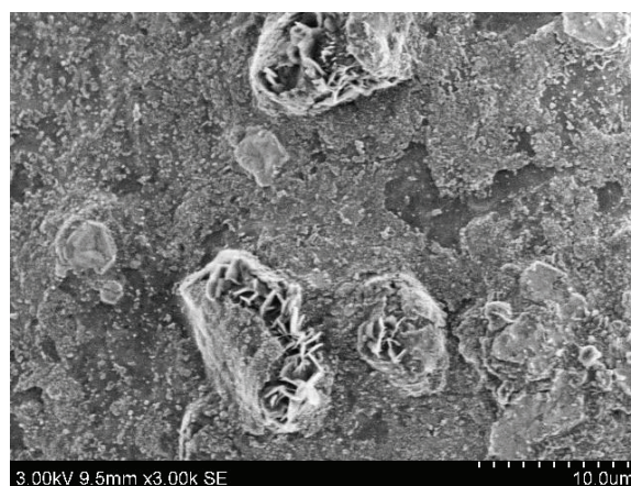
Рис. 3. Микрофотография пленки амина, обработанного калием кремнекислым при T=25\text{ }^{\circ}\text{C} (СЭМ, увеличение 3000X)
