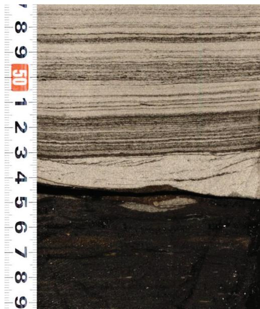
**Рис. 2.** Фото керна – эрозионная граница между пачками №№ 4 и 5 Казанского месторождения. В нижней части фото – уголь; фация приморского болота. В верхней части – песчаник с тонкой субгоризонтальной слоистостью, подчеркнутой углефицированным растительным детритом и являющейся результатом быстрого течения; фация приливного канала. Скв. 122 к. 11 Казанского месторождения Глубина по ГИС 2525,57 м
