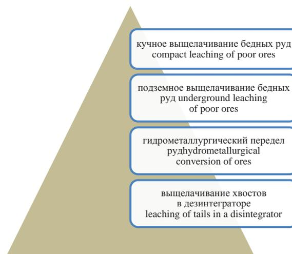
Рис. 2. Варианты технологий с выщелачиванием металлов из руд
