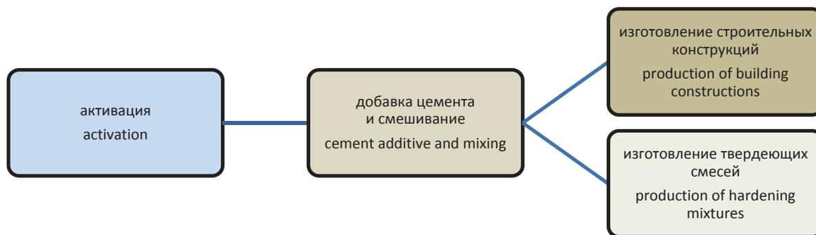
Рис. 5. Технологическая схема изготовления бетонных изделий
