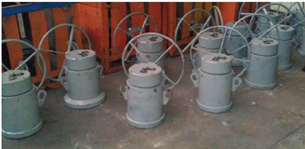
Рис. 5. Ручные приводы четверть оборотного шарового крана ДУ 300 на основе ПКП
