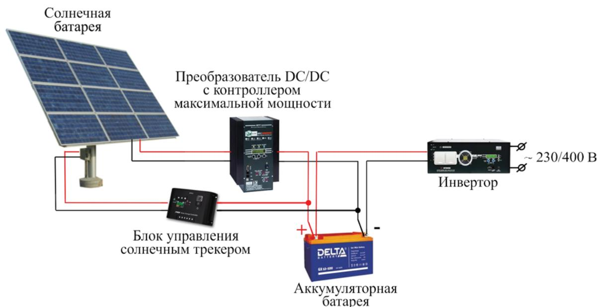
Рис. 1. Схема построения автономной фотоэлектрической станции
