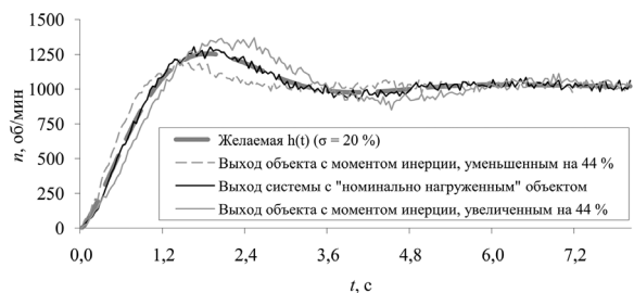
Рис. 8. Результаты работы синтезированного регулятора системы 4
