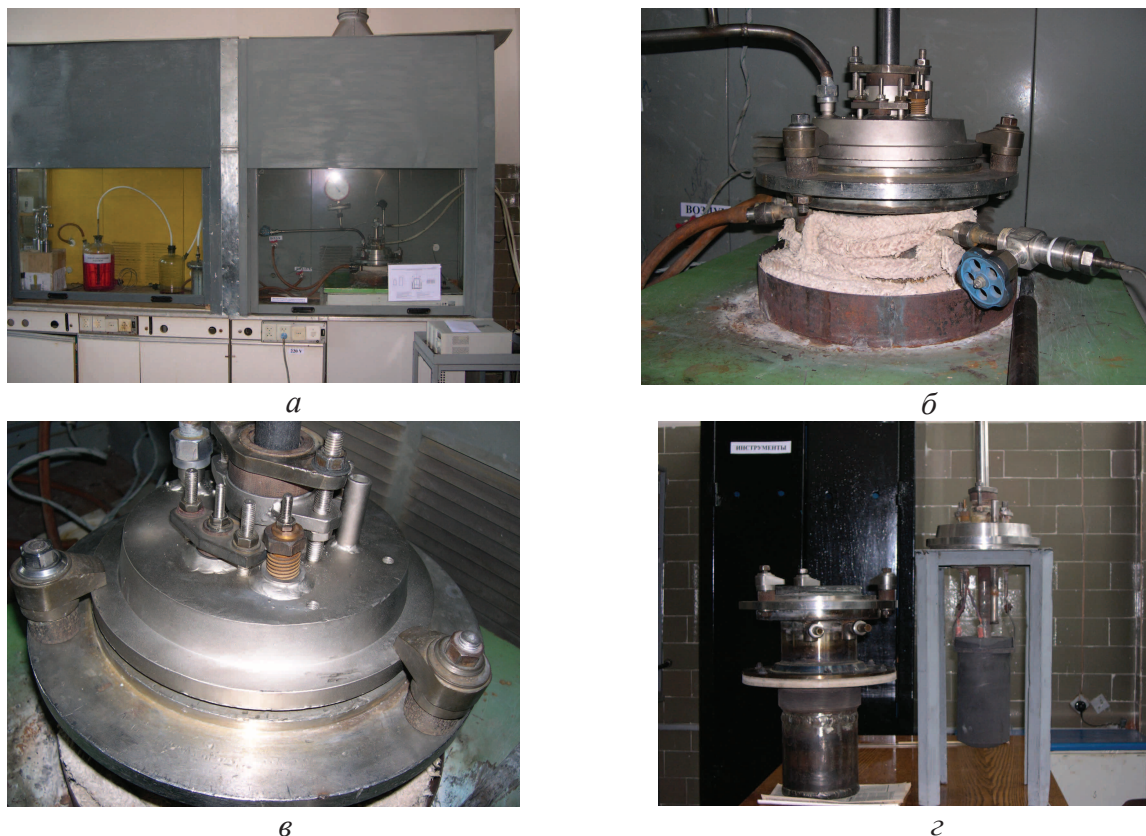
Рис. 2. Опытная установка электролитического разложения тетрафторида титана: а) общий вид установки; б) герметичный электролизер; в) никелированная крышка электролизера; г) графитовый тигель – анод с анодными токоподводами (внизу), металлический катод (вверху) и реторта электролизера (слева)
