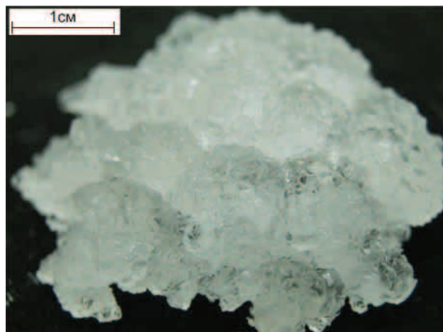
Рис. 2. Оплав и спек десублимата гексафторосиликата аммония
