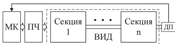
Рис. 2. Функциональная схема многосекционного вентильно-индукторного электропривода
