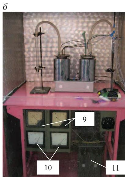
**Рис. 2.** Принципиальная схема лабораторной установки теплотехнологической переработки низкосортного сырья (а) и ее вид в сборе (б): 1 – нагревательный элемент, 2 – реактор, 3 – система термпар, 4 – регистратор температуры, 5 – термостойкий шланг, 6 – емкость-холодильник, 7 – дополнительный холодильник, 8 – опора, 9 – амперметр, 10 – вольтметр, 11 – автотрансформатор
