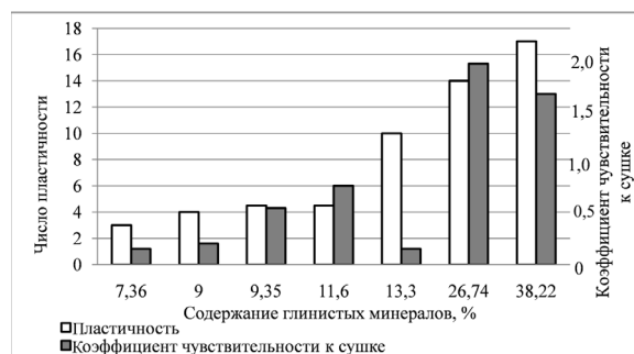
Рис. 3. Зависимость технологических свойств от содержания в глинистом сырье фракций менее 1 мкм
