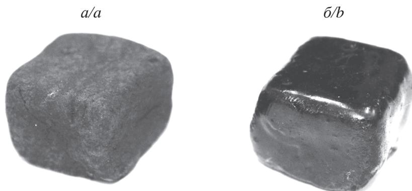
**Рис. 1.** Фотография композитного топлива: а) без нанесения смолы; б) с защитным слоем из пиролизной смолы
