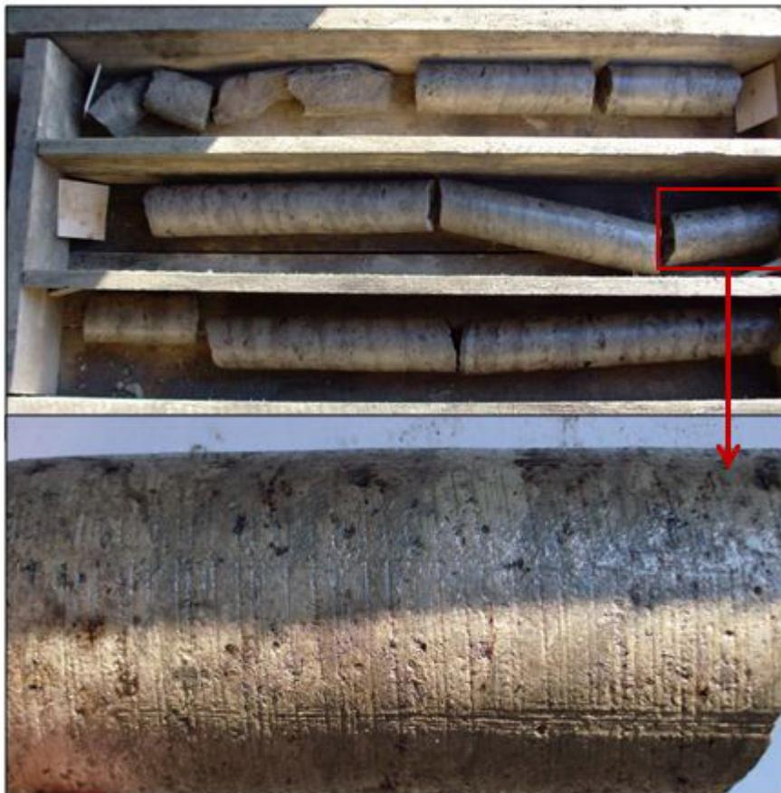
*Рис. Фотография ядра из отложений VII пачки, скважина 289r2 Речицкая (гл. 2250-2253 м, К №1*
