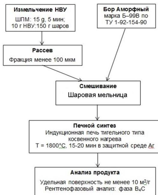
Рисунок 5.1 – Химико–технологическая схема процесса синтеза карбида бора
