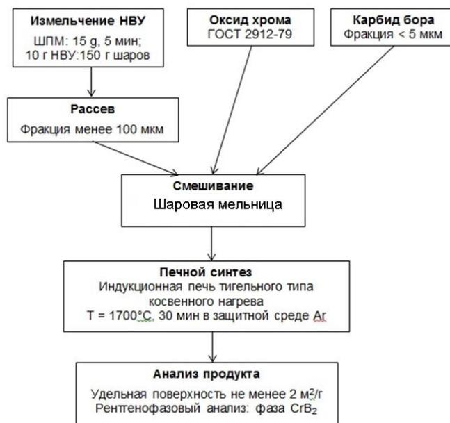
Рисунок 5.3 – Химико–технологическая схема процесса синтеза диборида хрома
