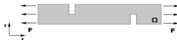
Рис. 1. Форма пластины без армирования и расчетная схема
