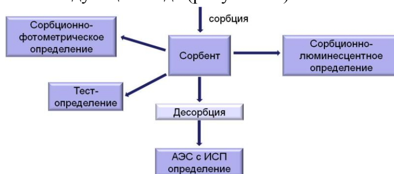
Рисунок 71. Схема использования химически модифицированного силикагеля для сорбционно-спектроскопического определения металлов
