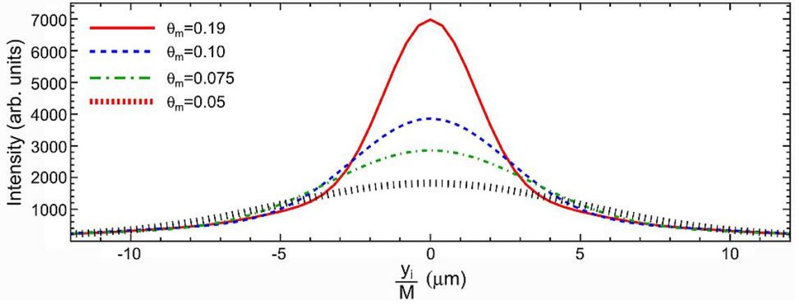
Рисунок 2.32 — Вертикальные профили изображения пучка для различных апертур линзы, взятые в точке идеальной фокусировки ( $x_i/M = 0$ )
