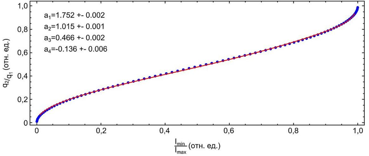
Рисунок 2.22 — Зависимость нормированного на положение максимума SPF размера электронного пучка  $q_2/q_1$  от относительной глубины провала в двугорбом распределении изображения пучка  $I_{min}/I_{max}$ . Точки – расчёт для  $q_1 = 1,8$  мкм, сплошная кривая – аппроксимация функцией (2.20). Значения свободных параметров аппроксимации указаны на рисунке
