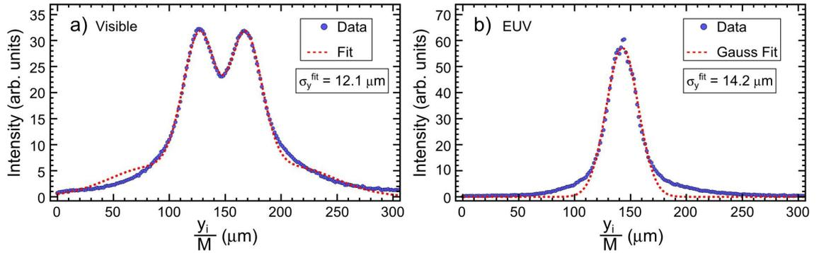
Рисунок 4.18 — Вертикальные проекции изображений пучка конфигурации 2 в разных спектральных диапазонах (точки) и результаты аппроксимации
