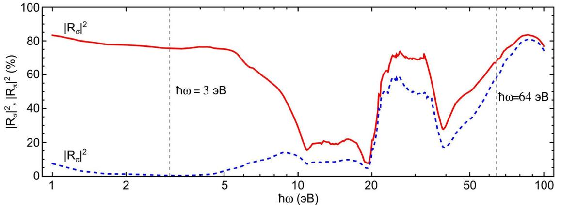
Рисунок 4.13 — Зависимость коэффициентов отражения молибдена от энергии фотона для угла падения  $\alpha = 16^\circ$ . Вертикальные серые штриховые линии показывают энергии фотонов, соответствующие используемым в эксперименте фильтрам
