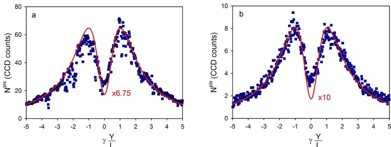
Рисунок 4.8 — Рассчитанные (сплошная красная линия) и измеренные (синие квадраты) вертикальные сечения пространственных распределений обратного переходного излучения в  $\gamma X/L = 0$  для пучка №1, Al фильтра толщиной 1,3 мкм и углов  $\alpha = 28,1^\circ$  (а),  $\alpha = 67,5^\circ$  (б). Для упрощения сравнения теоретические кривые масштабированы по интенсивности. Коэффициент масштаба составил 6,75 для угла  $\alpha = 28,1^\circ$  и 10 для угла  $\alpha = 67,5^\circ$
