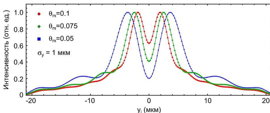
Рисунок 2.2 — К вопросу о влиянии оптической системы на получаемое изображение. Вертикальное сечение изображения пучка с размером  $\sigma_y = 1,0$  мкм, полученное при различных значениях числовой апертуры линзы. Изображение получалось сверткой чистого SPF и Гаусова профиля пучка. Параметры расчёта  $\lambda = 400$  нм,  $M = 1$
