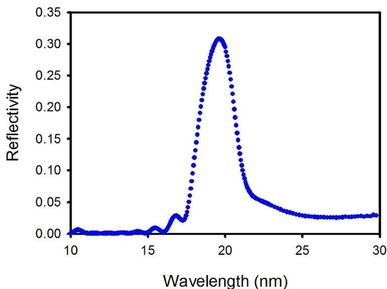
Рисунок 4.10 — Спектральная зависимость отражающей способности многослойного Mo/Si зеркала, измеренная на пучке синхротрона BESSY II (Берлин, Германия)
