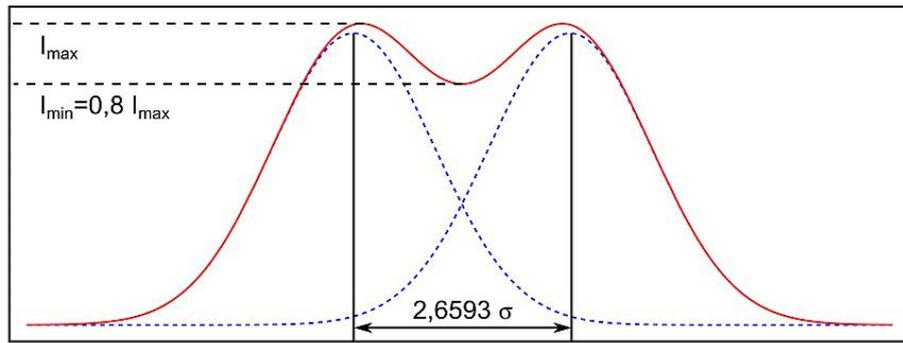
Рисунок 2.21 — К вопросу о разрешимости двух гауссовых распределений с шириной  $\sigma$ . Критерий различимости – относительная интенсивность в провале -  $I_{min} = 80\%I_{max}$
