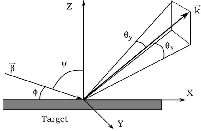
Рисунок 4.2 — Схема теоретического расчёта обратного переходного излучения при наклонном падении по модели В.Е. Пафомова
