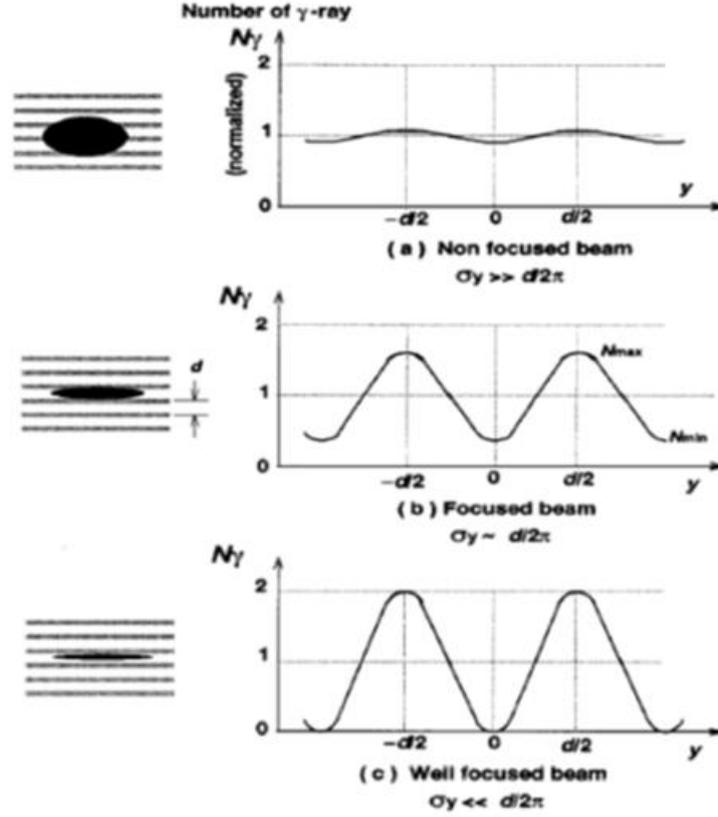
Рисунок 1.4 — Принцип получения информации о размере электронного пучка для монитора Шинтаке. Рисунок перерисован из работы [64].
