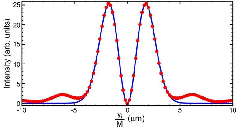
Рисунок 2.11 — Рассчитанное распределение SPF (точки) и аппроксимация с использованием функции (2.16) (линия). Параметры расчёта SPF совпадают с параметрами для рисунка 2.6 для идеальной фокусировки ( $\Delta a = 0$ )
