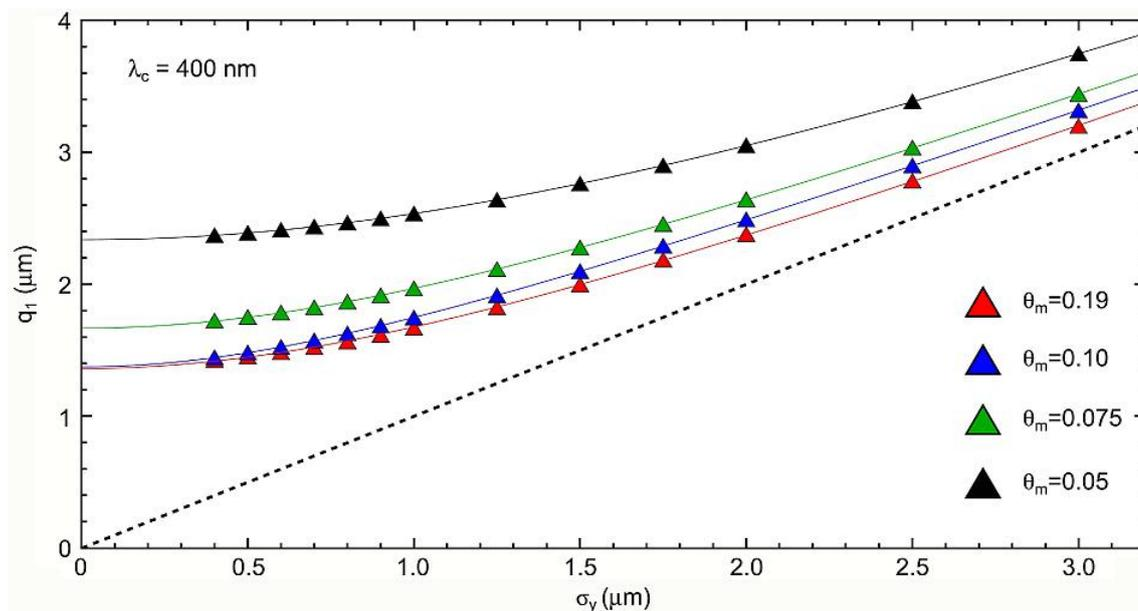
Рисунок 2.35 — К вопросу о соответствии между собой реального вертикального размера пучка  $\sigma_y$  и размера  $q_1$ , получаемого из аппроксимации с помощью функции (2.27)
