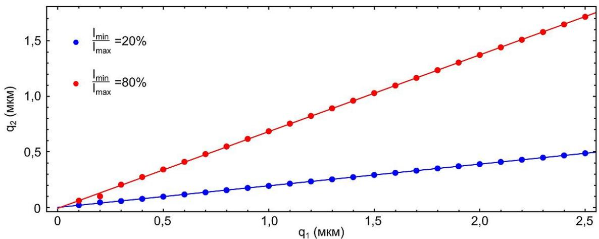
Рисунок 2.20 — Зависимость вертикального размера пучка, при котором относительная глубина провала двугорбого распределения изображения пучка составляет 20% (синие точки) и 80% (красные точки), от от положения максимума в распределении чистого SPF, посчитанное по формуле (2.19). Сплошные линии показывают линейную аппроксимацию полученных данных
