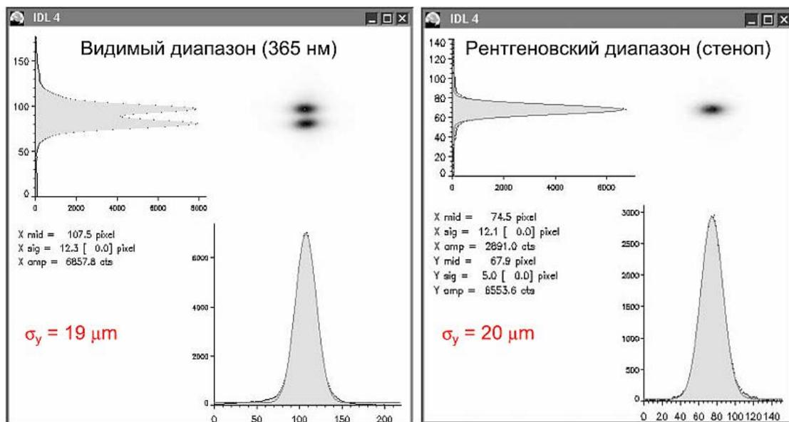
Рисунок 1.8 — Изображения пучка на основе СИ, измеренные в видимом диапазоне (вертикальная поляризация) - слева и на основе рентгеновского стенопа - справа.
