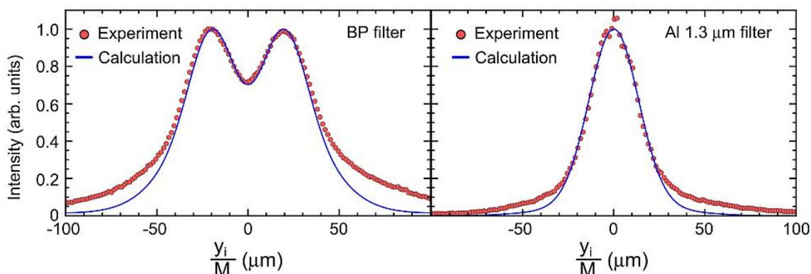
Рисунок 4.21 — Сравнение рассчитанных профилей пучка для  $\Delta a = 1,45$  мкм и экспериментально измеренных проекций пучка в видимом и ВУФ диапазоне при  $\sigma_y^{real} = 12$  мкм
