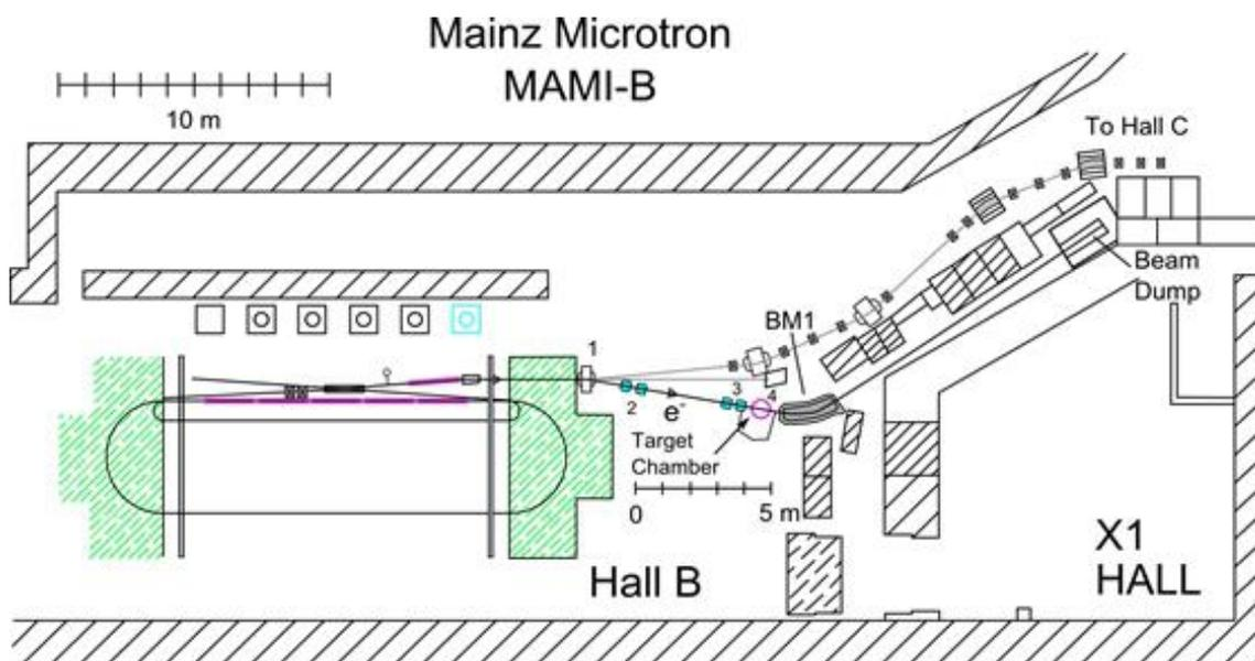
Рисунок 3.1 — Схема ускорительного зала ускорителя MAMI-B (секция на 855 МэВ)
