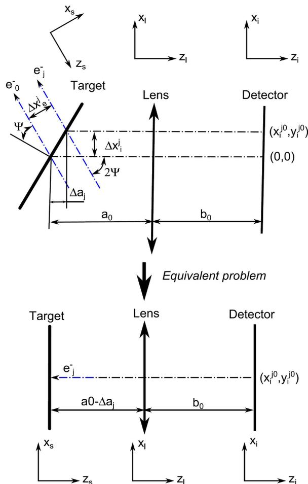
Рисунок 2.29 — Схема расчёта для случая наклонной геометрии и некоторые обозначения
