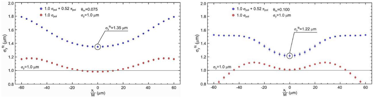
Рисунок 3.18 — Размеры пучка, полученные аппроксимацией вертикальных профилей изображений пучка для различных горизонтальных координат. Представлены результаты для «чистой» и «смешанной» поляризации, а также для числовых апертур  $\theta_m = 0,075$  рад и  $\theta_m = 0,10$  рад
