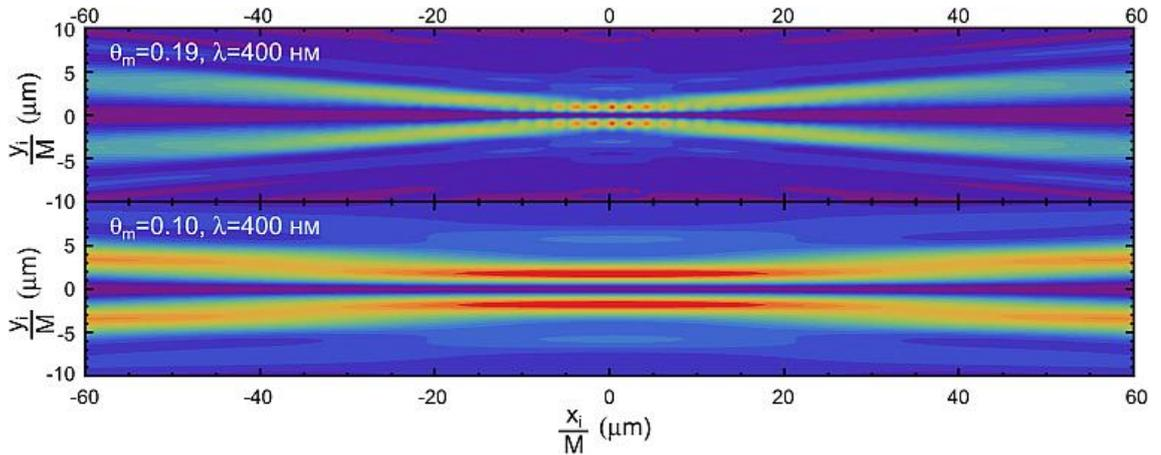
Рисунок 2.25 — Изображения пучка с дельта-образным вертикальным распределением для  $\theta_m = 0,10$  рад и  $\theta_m = 0,19$  рад,  $\lambda = 400$  нм
