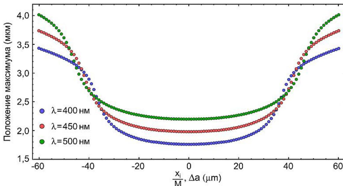
Рисунок 2.27 — Зависимости положения максимума в распределениях чистой SPF от горизонтальной координаты для  $\theta_m = 0,10$  рад и различных длин волн. Синие точки —  $\lambda = 400$  нм, красные точки —  $\lambda = 450$  нм, зелёные точки —  $\lambda = 500$  нм
