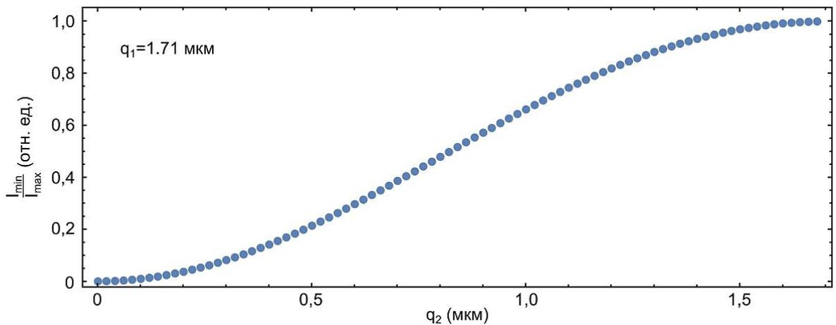
Рисунок 2.19 — Зависимость относительной глубины провала двугорбого распределения изображения пучка от размера вертикального размера электронного сгустка, посчитанное по формуле (2.19). При расчёте  $q_1 = 1,71$  мкм
