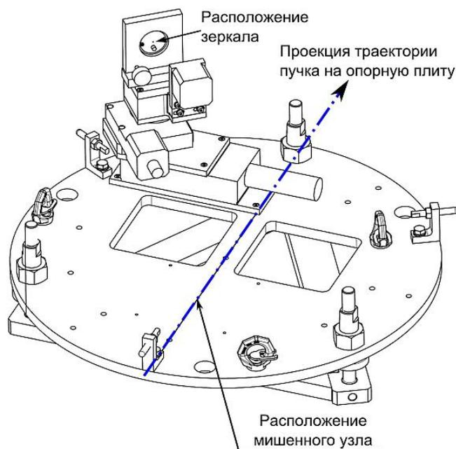
Рисунок 4.12 — Изометрия сборочного чертежа всей установки для визуализации на опорной плите без мишенного узла
