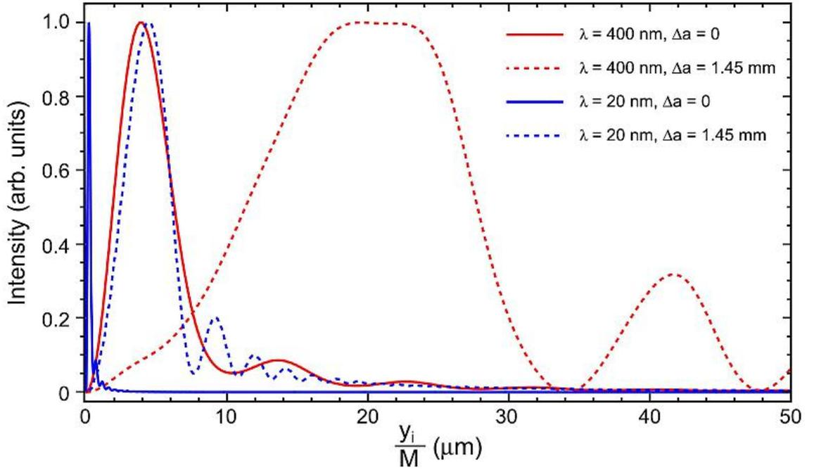
Рисунок 4.19 — Рассчитанные функции SPF для видимого и ВУФ диапазона при отсутствии и наличии расфокусировки
