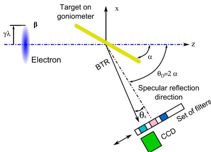
Рисунок 4.1 — Схема теоретического расчёта и проведения эксперимента по генерации обратного переходного излучения в спектральном диапазоне вакуумного ультрафиолета
