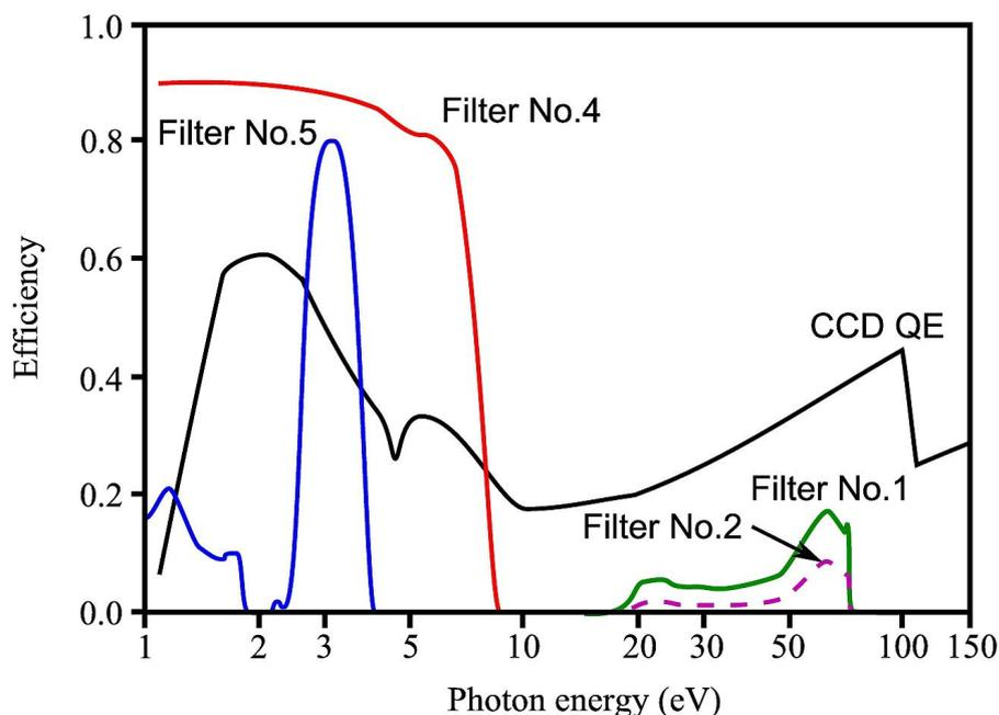
Рисунок 4.5 — Квантовая эффективность ПЗС-камеры (CCD QE) и кривые пропускания фильтров согласно таблице 2. Кривая для фильтра №3 не показана, чтобы не загромождать рисунок
