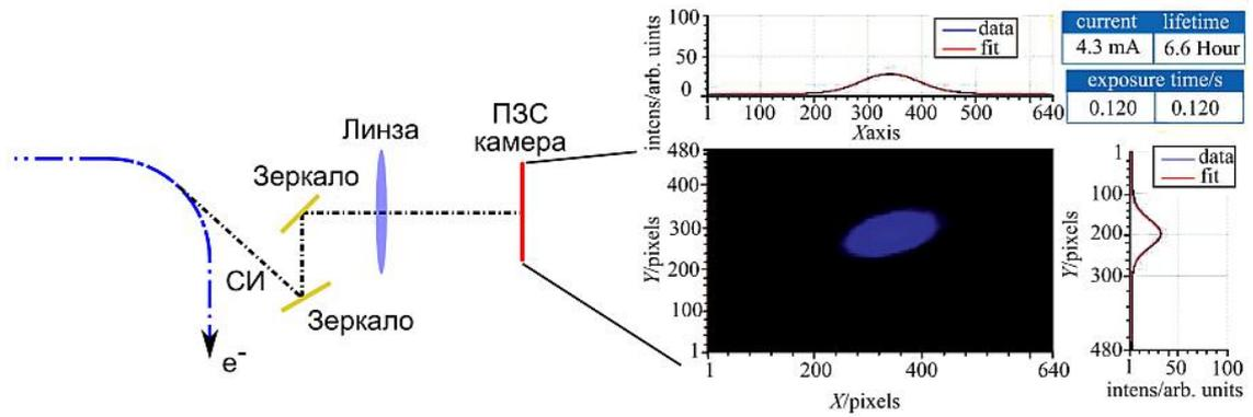
Рисунок 1.7 — Типичная схема на основе монитора визуализации СИ и пример полученного изображения. Рисунок перерисован из работы [76].
