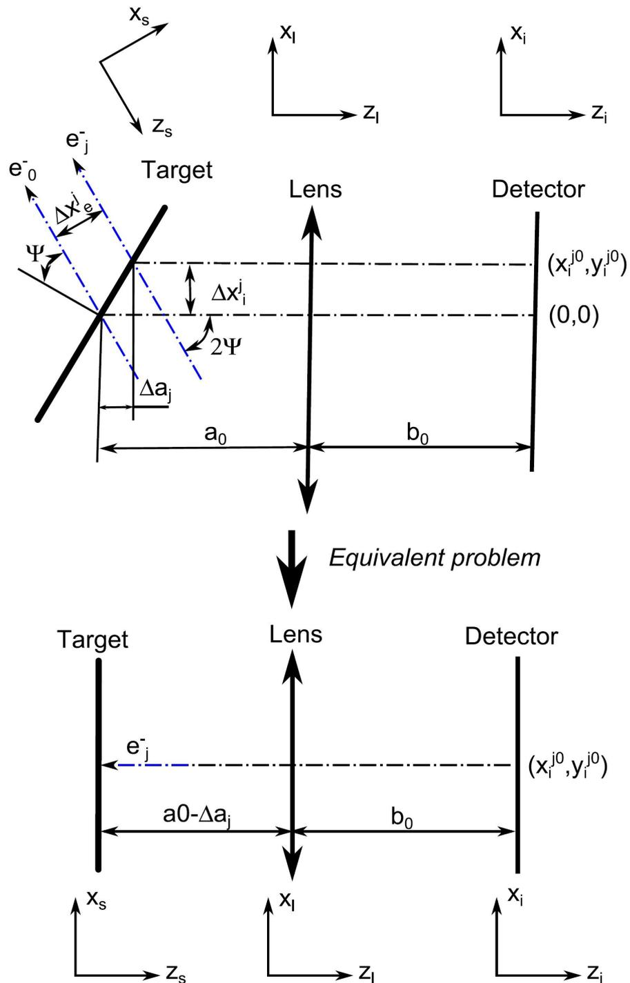
Рисунок 2.7 — Схема расчёта для случая наклонной геометрии и некоторые обозначения
