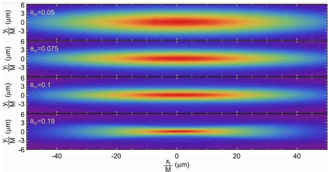
Рисунок 2.31 — Набор изображений пучка с вертикальным размером  $\sigma_y = 0,4$  мкм, горизонтальным размером  $\sigma_x = 30$  мкм при различных числовых апертурах линзы  $\theta_m = (0,05 \div 0,19)$  рад и длине волны  $\lambda = 400$  нм
