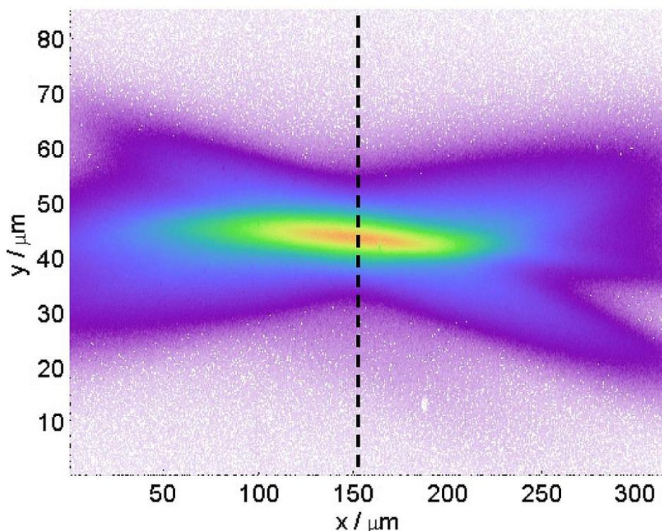
Рисунок 3.5 — Пример изображения пучка с использованием сцинтиллятора
