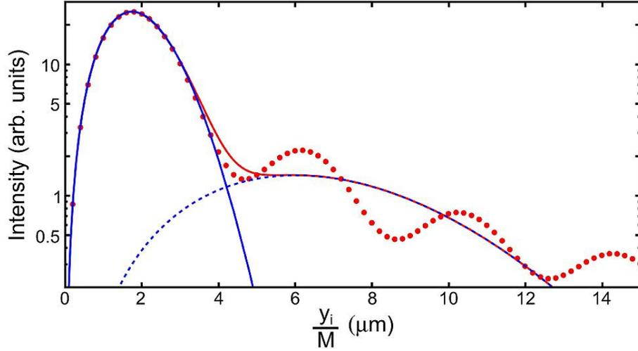
Рисунок 2.14 — Рассчитанное вертикальное распределение SPF (красные точки). То же самое распределение, что на рисунке 2.11. Сплошная синяя линия показывает первое слагаемое функции  $f_1^{mod}(y_i)$  в выражении (2.18), штриховая синяя линия показывает второе слагаемое, а сплошная красная линия показывает их сумму.
