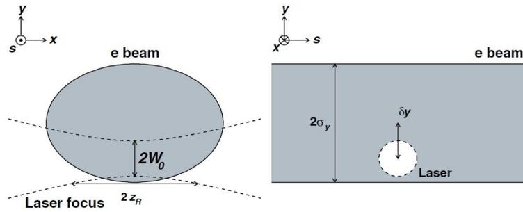
Рисунок 1.3 — Схема взаимодействия лазерного и электронного пучка и некоторые обозначения. Рисунок взят из работы [70]
