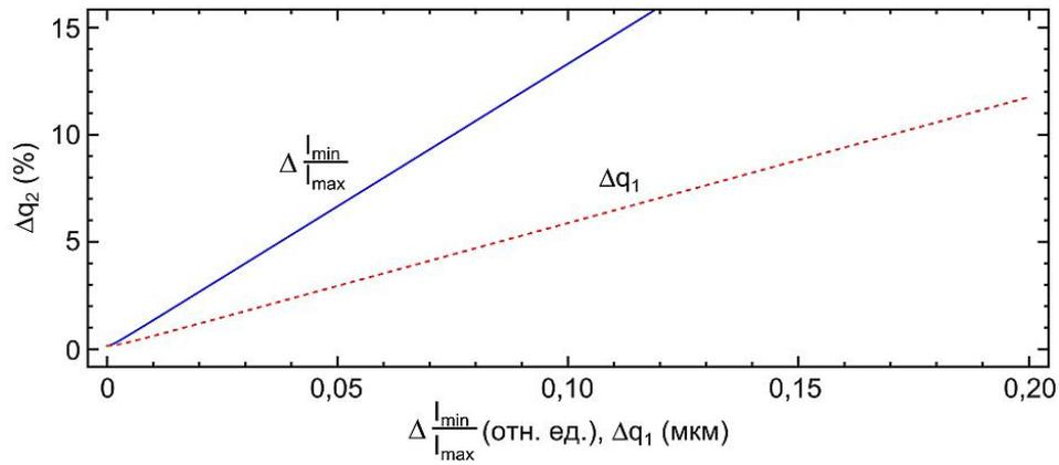
Рисунок 2.24 — Зависимости относительной неопределённости величины  $q_2$ , рассчитанные по формуле (2.21) от величин  $\Delta q_1$  и  $\Delta \frac{I_{min}}{I_{max}}$ . Значения параметров аппроксимации  $a_1 \dots a_4$  и их неопределённостей взяты и рисунка 2.22
