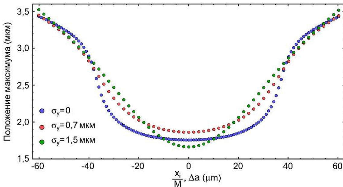
Рисунок 2.28 — Зависимости положения максимума в распределениях чистой SPF и изображения пучка от горизонтальной координаты для  $\theta_m = 0,10$  рад,  $\lambda = 400$  нм и различных размеров пучка волн. Синие точки — чистая SPF, красные точки —  $\sigma_y = 0,7$  мкм, зелёные точки —  $\sigma_y = 1,5$  мкм
