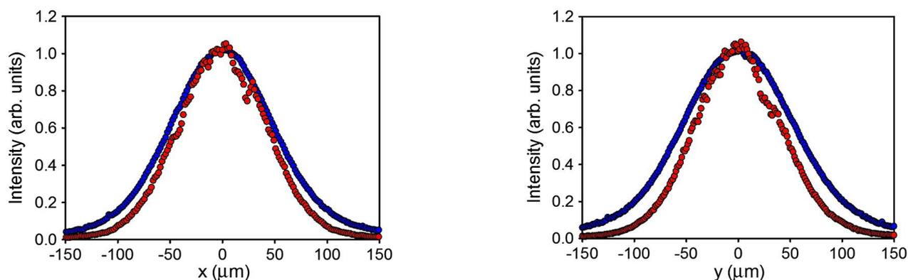
Рисунок 4.15 — Горизонтальная (слева) и вертикальная (справа) проекции пучка конфигурации 1, изображенного на рисунке 4.14, в видимом (синие точки) и ВУФ (красные точки) диапазонах
