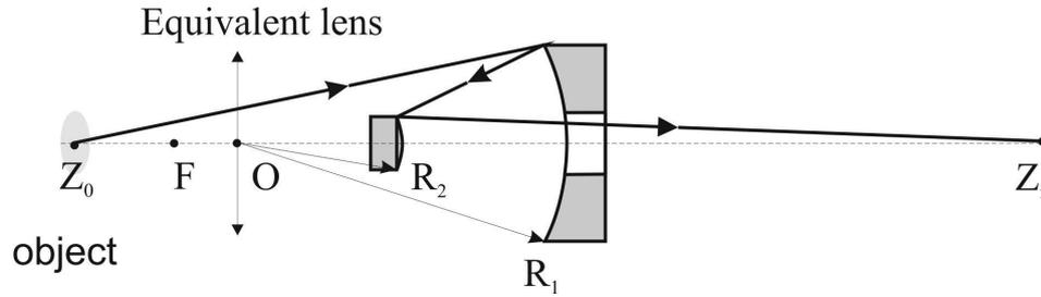
Рисунок 3.2 — Схема получения изображения с использованием объектива Шварцшильда. Рисунок взят из работы [146]
