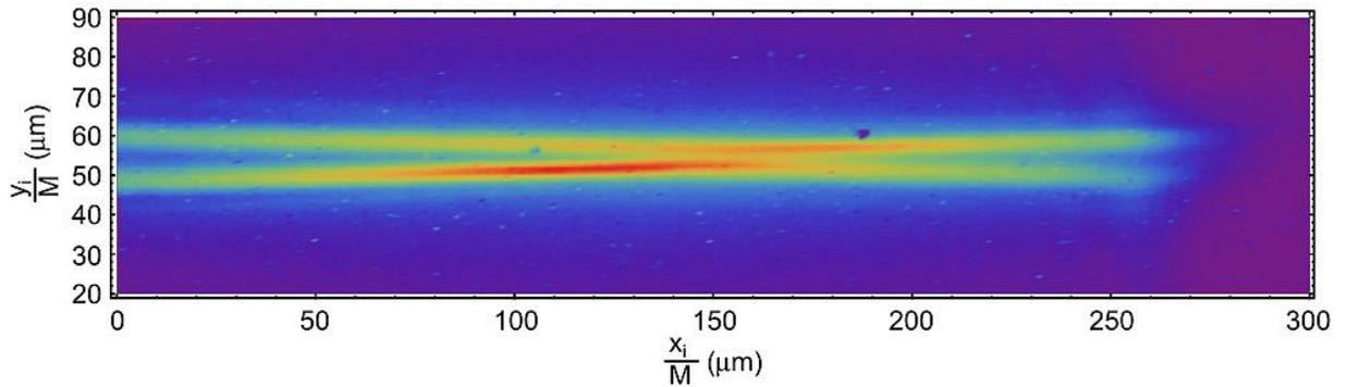
Рисунок 3.8 — Экспериментально полученное изображение пучка при использовании мишени Mo/Si и синего светофильтра 400 нм.
