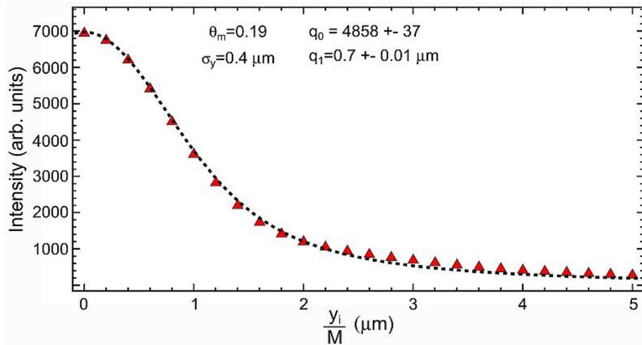
Рисунок 2.34 — Пример аппроксимации вертикального профиля изображения пучка с помощью функции (2.27)
