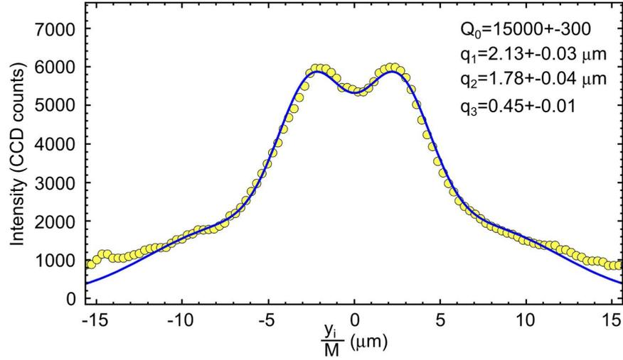
Рисунок 3.11 — Вертикальная проекция изображения пучка, показанного на рисунке 3.8, для координаты  $x_i/M = 160$  мкм шириной  $\pm 2$  пикселя (точки) и аппроксимация функцией (3.5) (сплошная линия). Параметры аппроксимации указаны на рисунке
