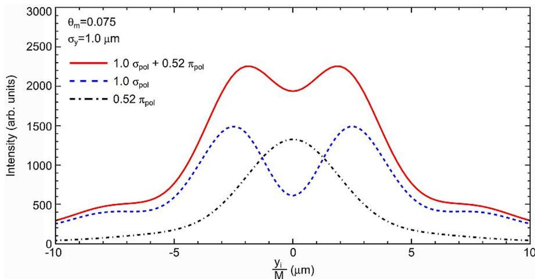
Рисунок 3.17 — Вертикальные профили изображений пучка с размером  $\sigma_y = 1,0$  мкм, показанных на рисунке 3.16, для различных компонент поляризации и их смеси.
