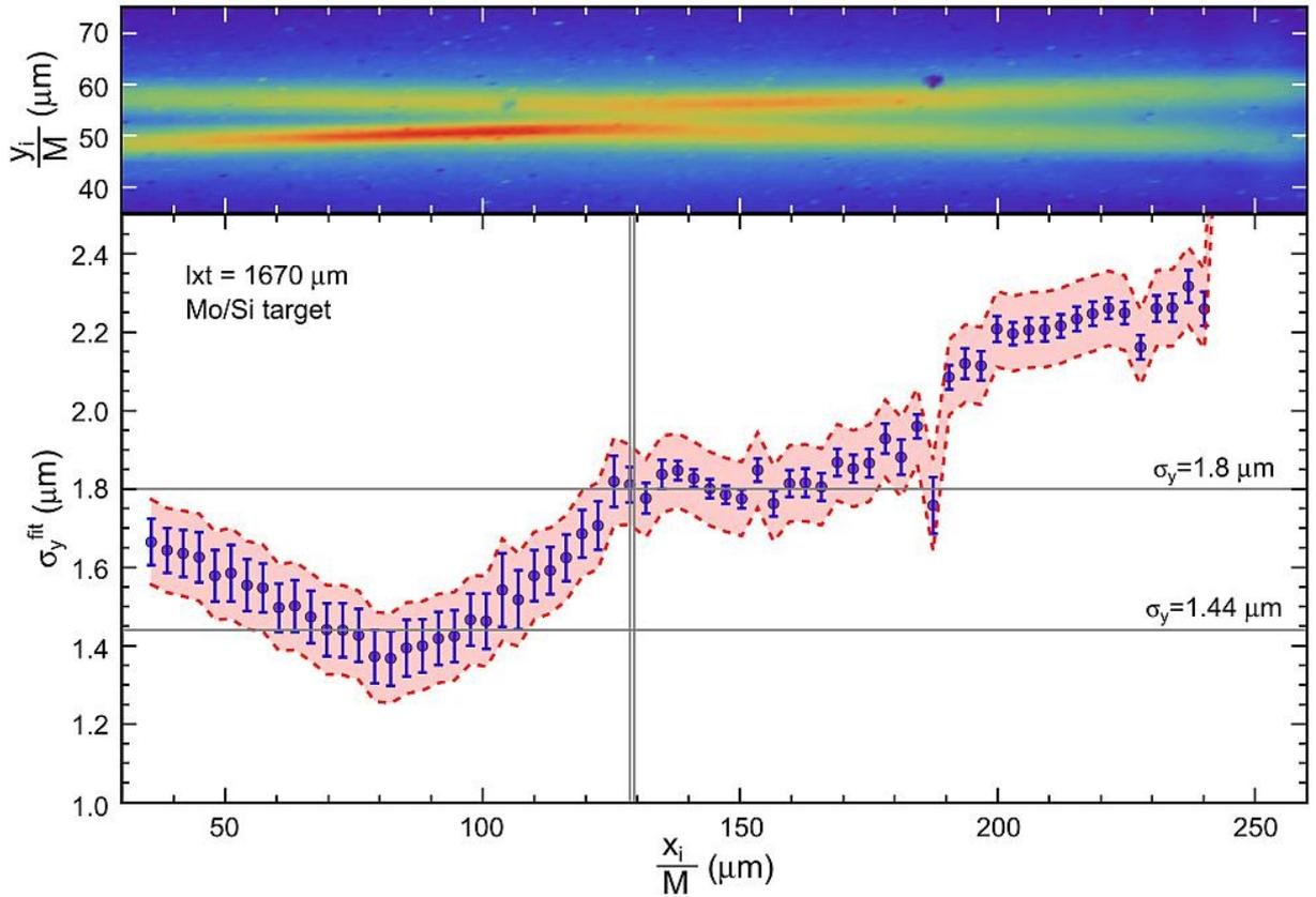
Рисунок 3.14 — Набор размеров пучка, полученных из вертикальных проекций изображения пучка, показанного на этом же рисунке сверху
