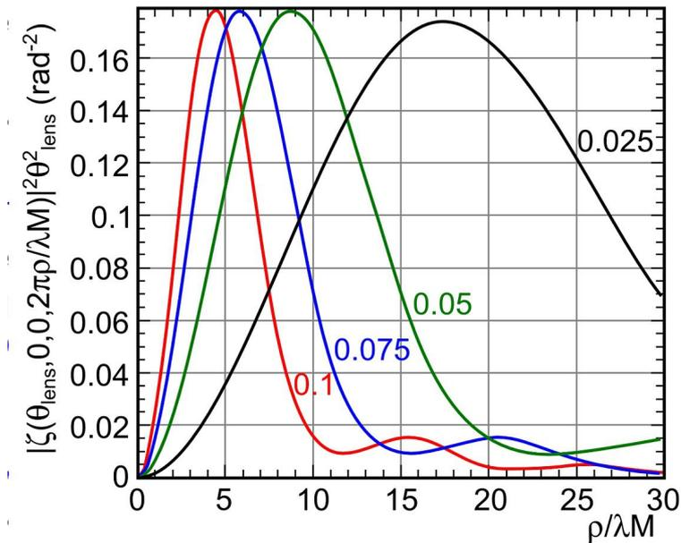
Рисунок 2.1 — Пространственное распределение SPF для различных угловых апертур линзы ( $\theta_m$ ) в радианах. По оси абсцисс отложена координата на детекторе. Рисунок перерисован из работы [21]
