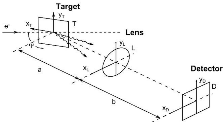
Рисунок 1.11 — Принцип работы монитора на основе обратного переходного излучения. Рисунок перерисован из работы [101]
