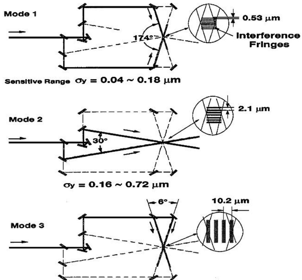
Рисунок 1.5 — Схема ориентации лазерных лучей для монитора Шинтаке, реализованная на пучка Стэнфордского линейного коллайдера. Рисунок перерисован из работы [64].
