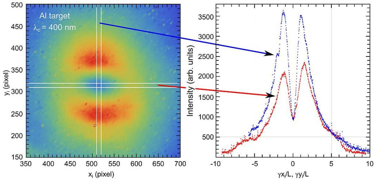
Рисунок 3.22 — Пространственное распределение обратного переходного излучения в видимом диапазоне от Al мишени и проекции, полученные в областях, отмеченных белыми линиями
