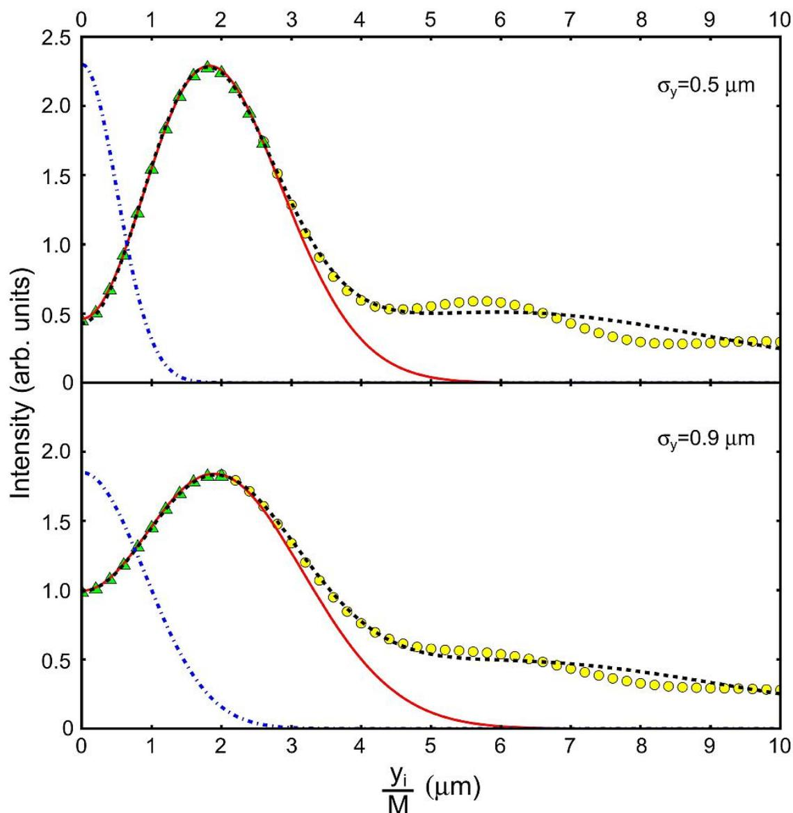
Рисунок 2.12 — Вертикальные профили рассчитанных изображений пучка при  $x_i = 0$  (как зелёные треугольники, так и желтые круги), аппроксимация согласно выражению (2.17) (сплошная красная линия) и аппроксимация согласно выражению (2.18) (черная штрихованная линия). Синяя штрих-пунктирная линия показывает вертикальный профиль пучка. Параметры расчёта изображения пучка такие же как для рисунка 2.9 при  $\theta_m = 0,10$  рад.
