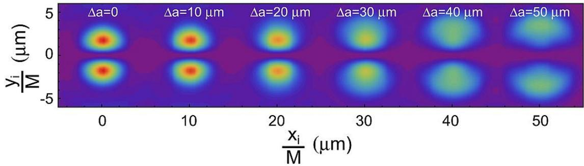
Рисунок 2.8 — Примеры рассчитанных SPF для электронов с различными горизонтальными сдвигами от центральной оси пучка. Горизонтальный размер пучка  $\sigma_x = 30$  мкм,  $\theta_m = 0,10$  рад.
