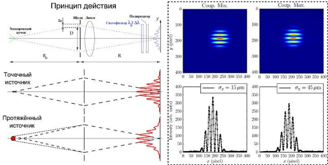
Рисунок 1.9 — Принцип действия интерферометра синхротронного излучения (слева) и пример полученных на синхротроне ALBA (Испания) интерферограмм. Рисунок перерисован из работы [89].
