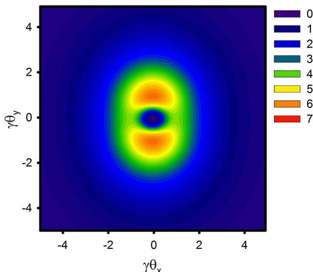
Рисунок 4.4 — Угловое распределение интенсивности монохроматического обратного переходного излучения, генерируемого сгустком населенностью  $10^{10}$  электронов при взаимодействии с молибденовой мишенью, наклоненной под углом  $\alpha = 28,1^\circ$ , рассчитанной по модели двойного токового слоя. Энергия электронов 855 MeV, длина волны излучения 20 нм
