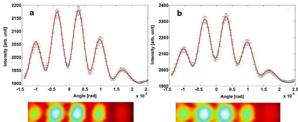
Рисунок 1.16 — Примеры измеренных экспериментальных интерферограмм. Слева размер пучка составлял  $\sigma_y = 31,3$  мкм, справа –  $\sigma_y = 95,4$  мкм. Рисунок взят из работы [119]
