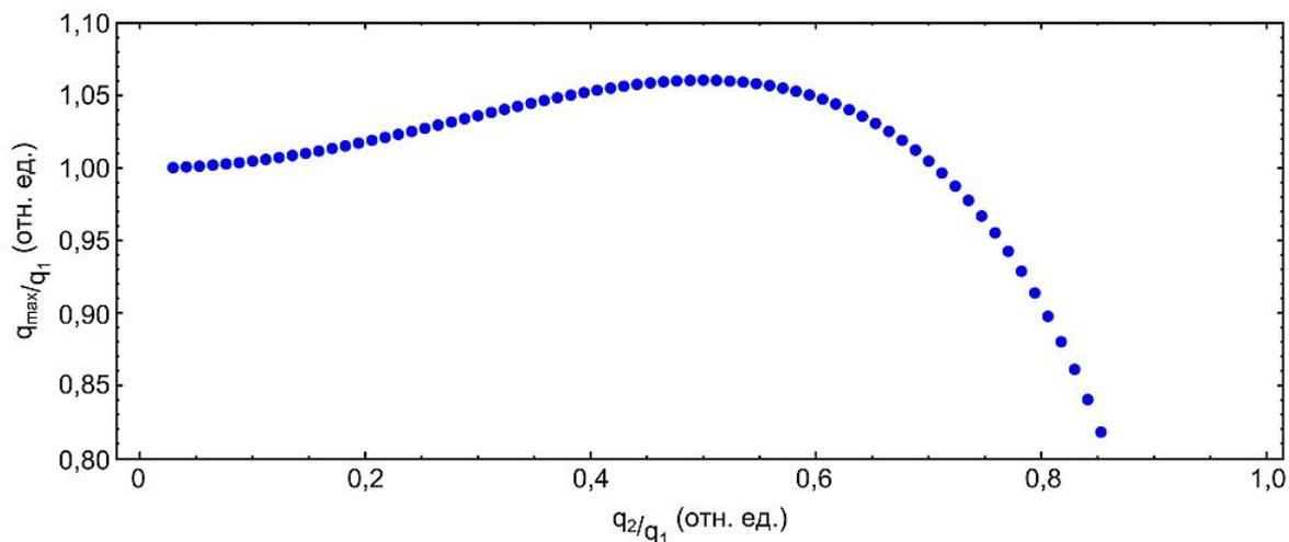
Рисунок 2.18 — Зависимость положения максимума в распределении изображения пучка ( $q_{max}$ ), нормированное на значение  $q_1$  от относительного размера пучка  $q_2/q_1$ .
