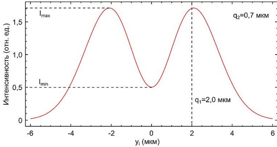
Рисунок 2.17 — Распределение, рассчитанное с использованием функции (2.19) и некоторые обозначения, используемые в дальнейшем. При расчёте  $q_1 = 2$  мкм,  $q_2 = 0,7$  мкм
