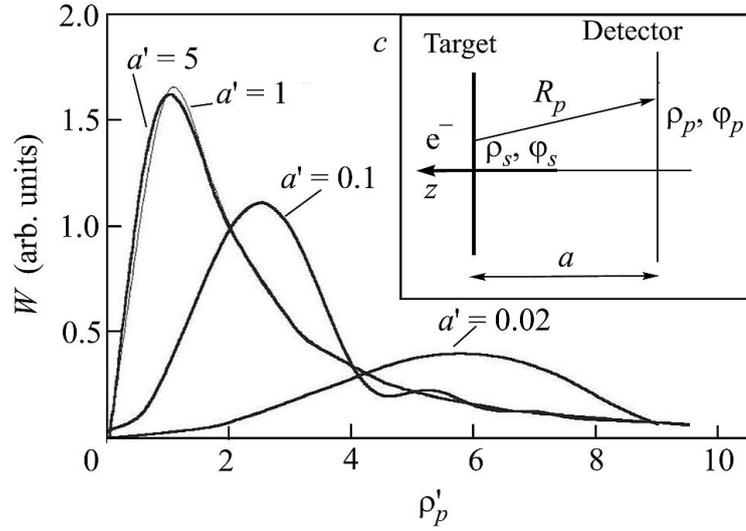
Рисунок 2.5 — Угловое распределение интенсивности переходного излучения при различных расстояниях  $a'$  между мишенью и детектором. На вставке показана цилиндрическая геометрия задачи
