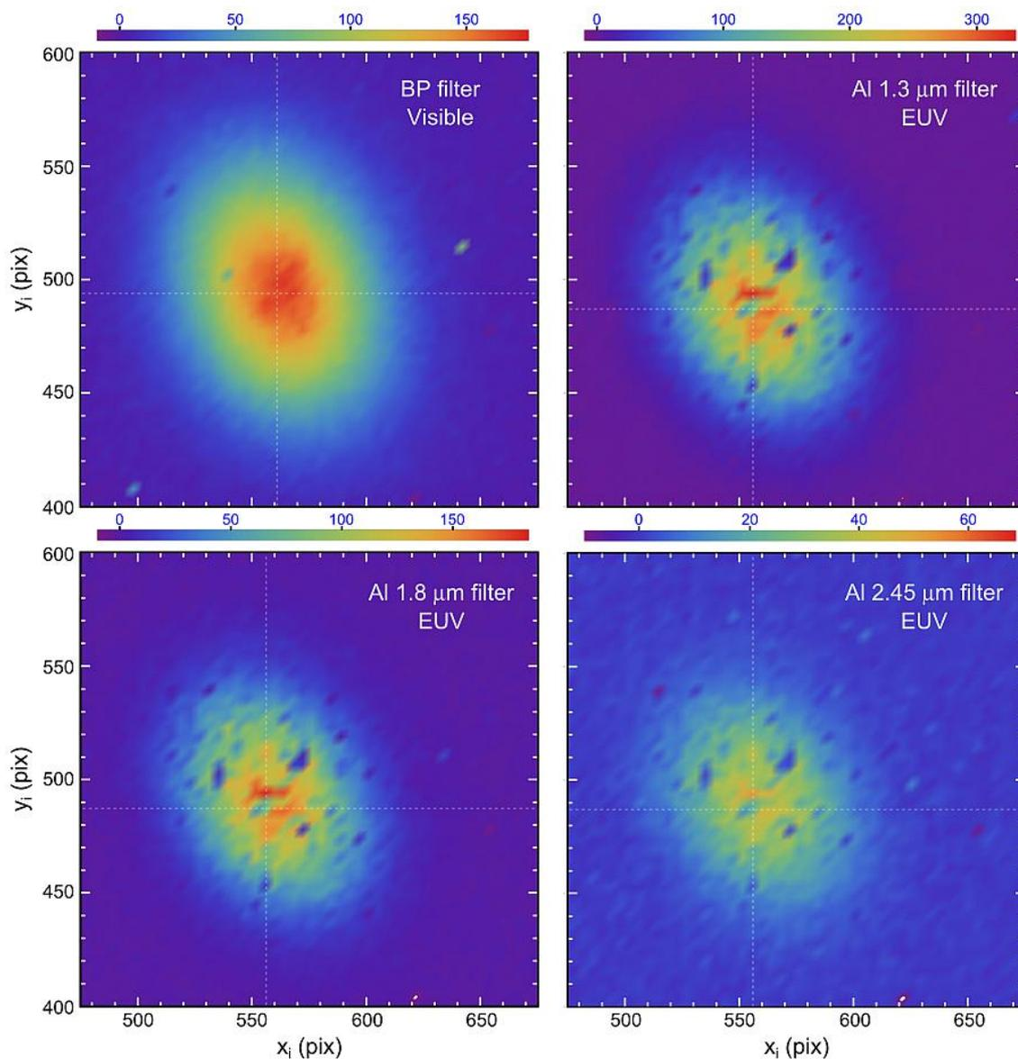
Рисунок 4.14 — Изображения пучка конфигурации 1 в разных спектральных диапазонах, полученные при использовании разных фильтров
