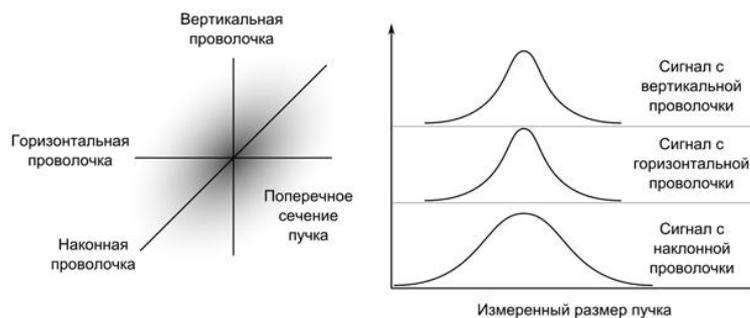
Рисунок 1.2 — Схема измерения профиля пучка тремя проволочками, призванная учесть возможный поворот пучка
