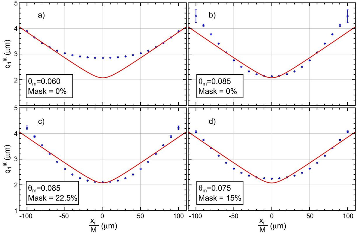
Рисунок 3.27 — Зависимость положения максимума в распределении чистой SPF для различных горизонтальных координат, полученная в расчётах при различных параметрах  $\theta_m$  и  $\delta$  (синие точки). Красная сплошная линия – аппроксимация экспериментальных данных функцией (3.14)
