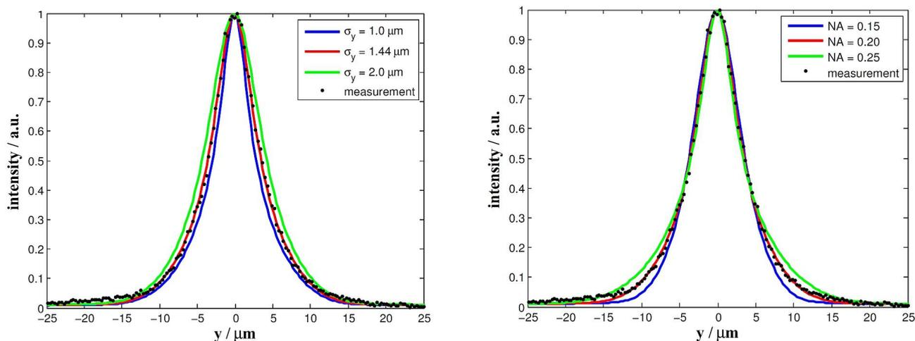
Рисунок 3.7 — Сравнение экспериментального профиля (точки) и результатов моделирования (сплошные линии). Слева – различные размеры пучка при числовой апертуре  $NA = 0,2$  рад; справа – различные числовые апертуры при размере пучка  $\sigma_y = 1,44$  мкм. Рисунок взят из совместной работы [109]
