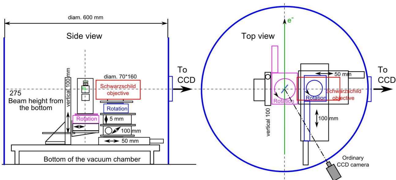
Рисунок 3.3 — Схематическое изображение экспериментальной станции для получения изображения с использованием объектива Шварцшильда. Схема выполнена с соблюдением масштаба
