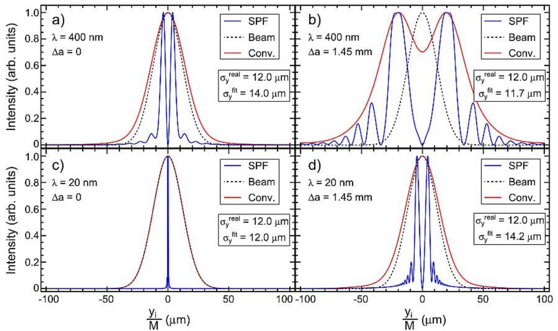
Рисунок 4.20 — Результаты свертки функций SPF для видимого и ВУФ диапазона при отсутствии и наличии расфокусировки с Гауссовым пучком размером  $\sigma_y^{real} = 12$  мкм. Представлены также результаты аппроксимации и полученные значения размера пучка
