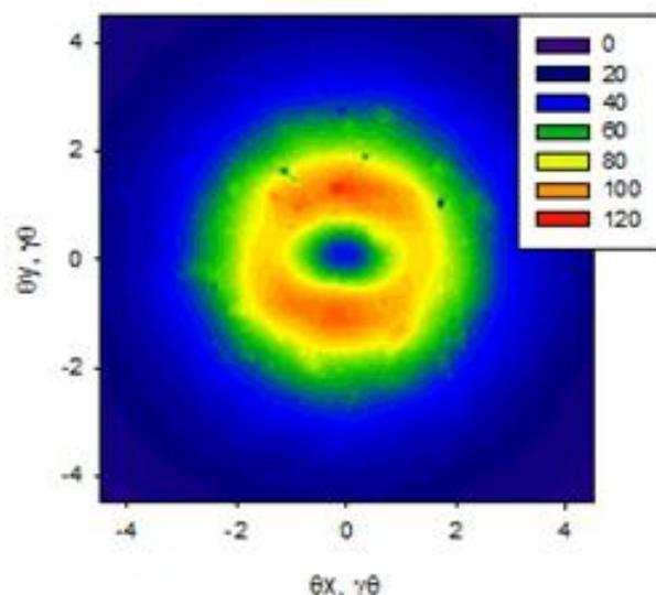
Рисунок 4.7 — Пространственное распределение интенсивности обратного переходного излучения для пучка №3 и геометрии излучения  $\alpha = 67,5^\circ$
