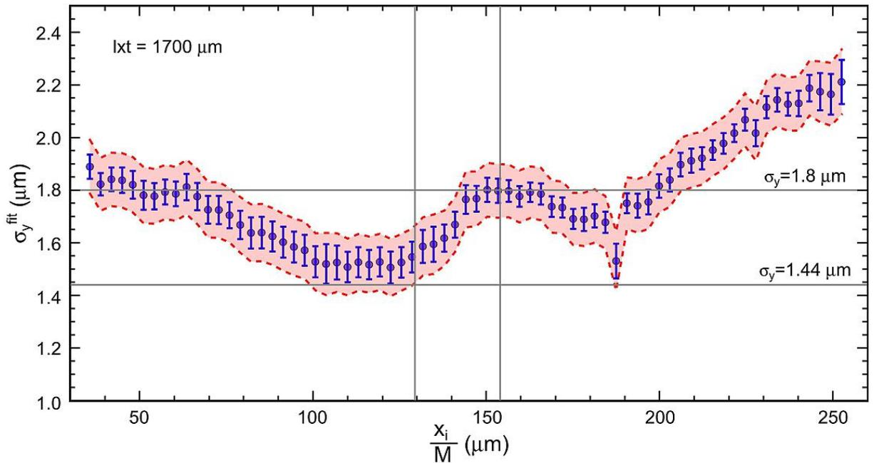
Рисунок 3.13 — Набор размеров пучка, полученных из вертикальных проекций изображения пучка, показанного на рисунке 3.8
