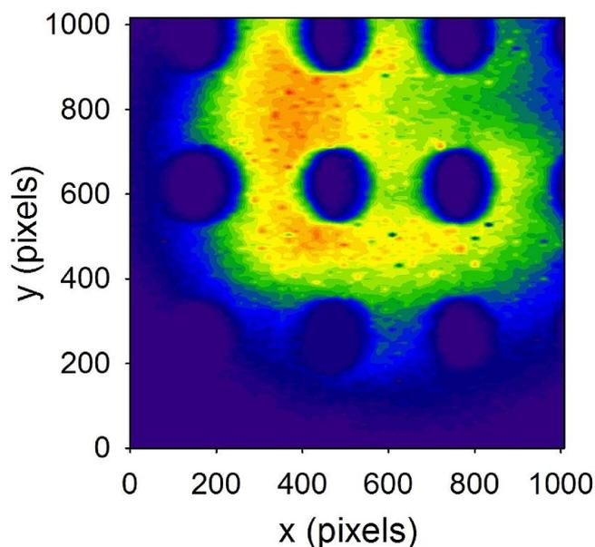
Рисунок 4.11 — Пример полученного изображения калибровочной мишени
