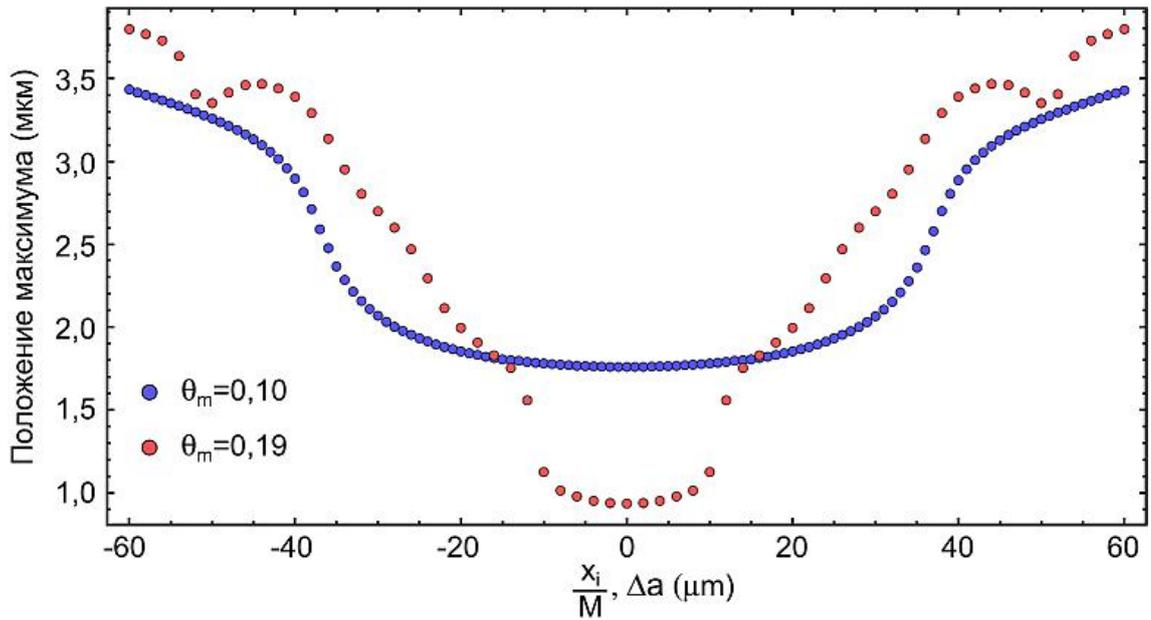
Рисунок 2.26 — Зависимости положения максимума в распределениях, показанных на рисунке 2.25, от горизонтальной координаты при  $\lambda = 400$  нм
