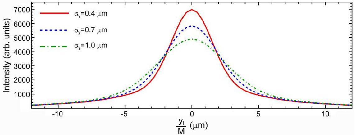
Рисунок 2.33 — Вертикальные профили изображения пучка на примере трёх размеров ( $\sigma_y = 0,4; 0,7; 1,0$  мкм) для апертуры линзы  $\theta_m = 0,19$  рад, взятые в точке идеальной фокусировки ( $x_i/M = 0$ )
