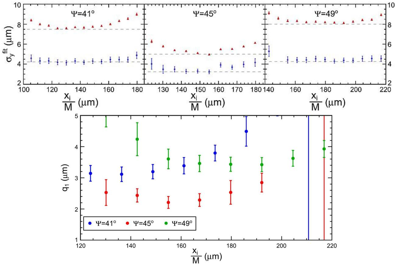
Рисунок 3.25 — Горизонтальное распределение вертикальных размеров пучка (сверху), полученное для функции аппроксимации (3.5) (синие точки) и функции распределения Гаусса (красные точки). Полученные распределения величины параметра  $q_1$  (снизу)
