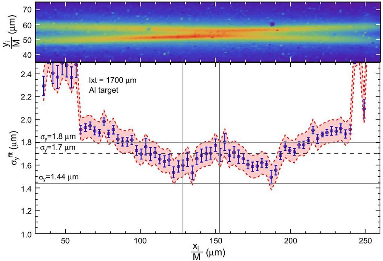
Рисунок 3.21 — Набор размеров пучка, полученных из вертикальных проекций изображения пучка, показанного на данном рисунке сверху для Al мишени. Штриховая линия показывает размер пучка  $\sigma_y^{\text{fit}} = 1,7$  мкм
