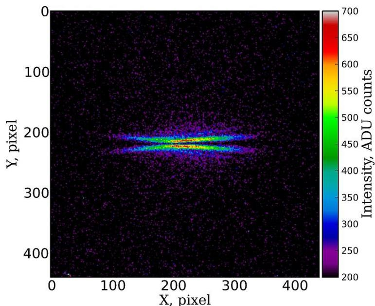
Рисунок 2.3 — Пример экспериментально полученного бананообразного изображения поперечного профиля электронного пучка. Вертикальная компонента поляризации переходного излучения. Рисунок взят из работы [124]
