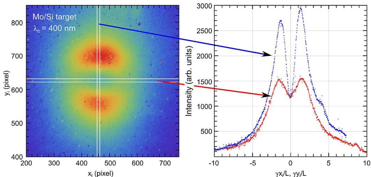
Рисунок 3.15 — Пространственное распределение обратного переходного излучения в видимом диапазоне от Mo/Si мишени и проекции, полученные в областях, отмеченных белыми линиями
