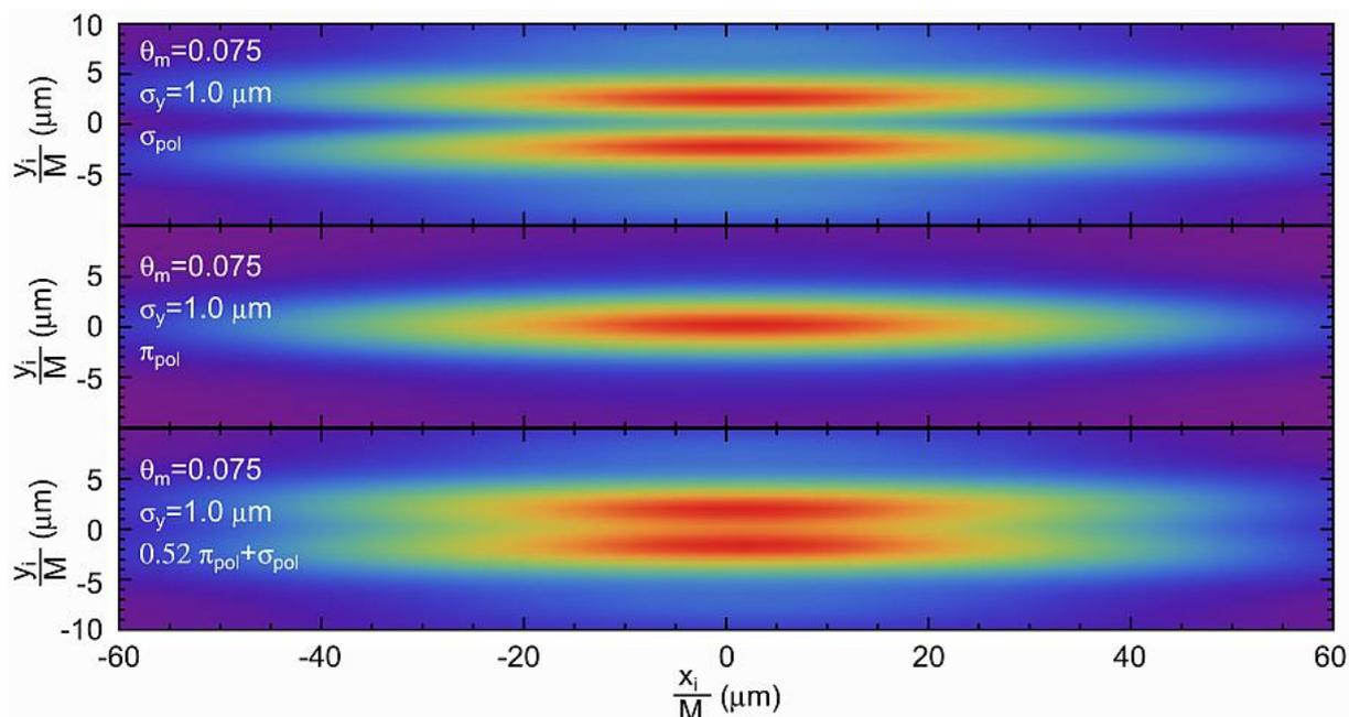
Рисунок 3.16 — Рассчитанные изображения пучка с размером  $\sigma_y = 1,0$  мкм для различных компонент поляризации и их смеси
