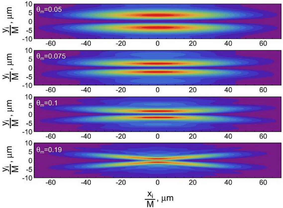
Рисунок 2.9 — Примеры рассчитанных двумерных изображений пучка для размеров пучка  $\sigma_x = 30$  мкм,  $\sigma_y = 0,4$  мкм и для различных апертур линзы  $\theta_m$ : (сверху-вниз)  $\theta_m = 0,05$  рад,  $\theta_m = 0,075$  рад,  $\theta_m = 0,10$  рад,  $\theta_m = 0,19$  рад
