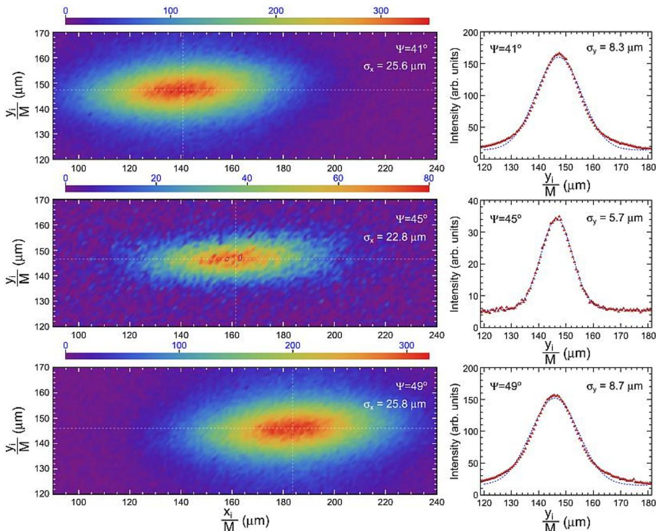
Рисунок 3.24 — Изображения пучка, полученные при осевой и внеосевой визуализации, (слева) и вертикальные проекции соответствующих изображений (справа)
