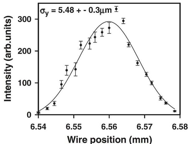
Рисунок 1.1 — Пример измерения вертикально профиля пучка с энергией 1,28 ГэВ вольфрамовой проволочкой диаметром 10 мкм. Рисунок взят из работы [65]
