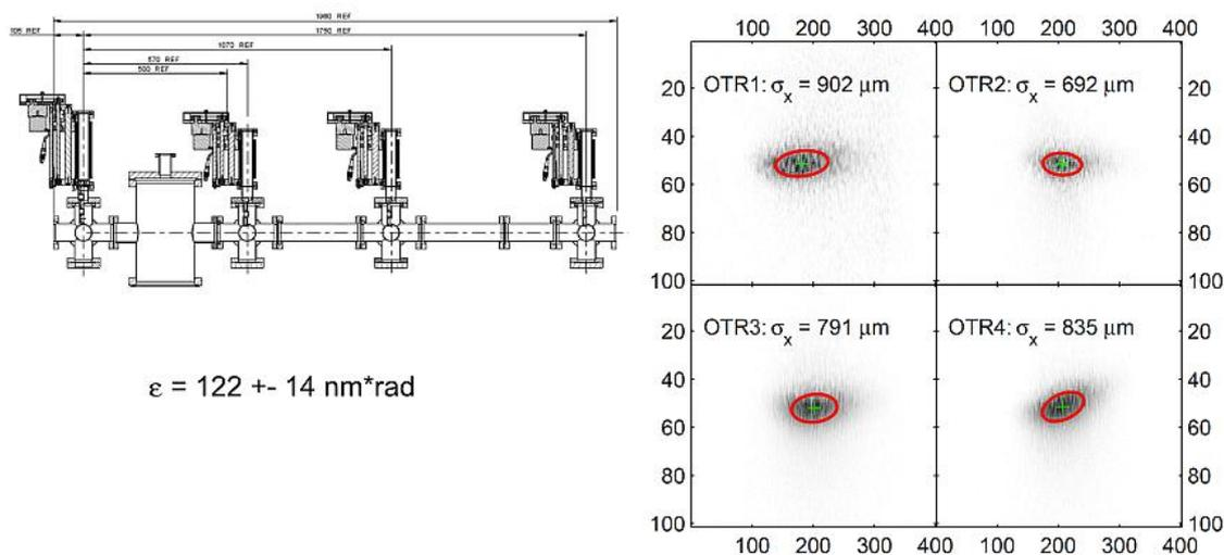
Рисунок 1.12 — Пример монитора по измерению эмиттанса пучка на основе одновременного измерения размера в четырех местах с использованием переходного излучения. Рисунок перерисован из работы [103]
