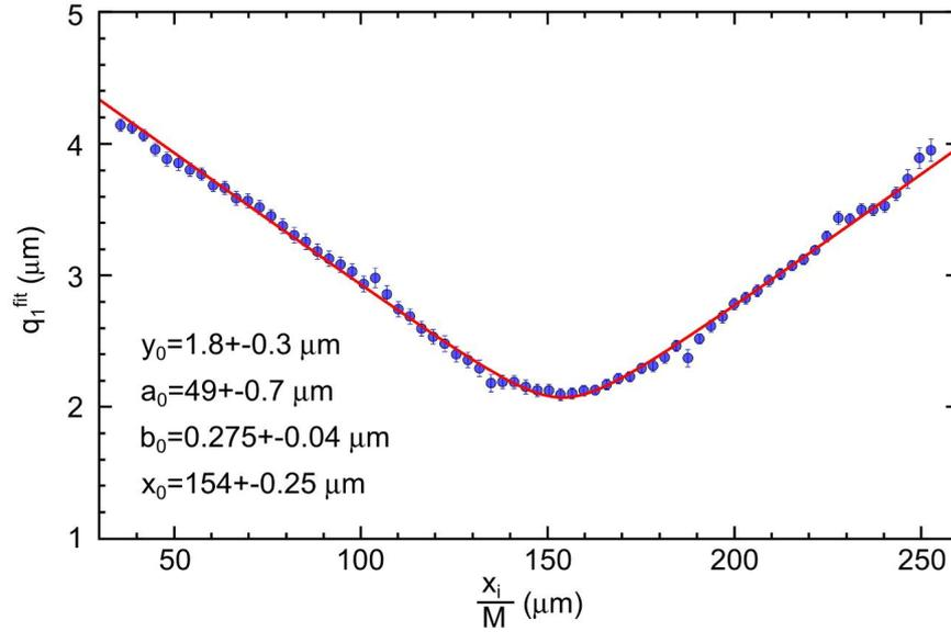
Рисунок 3.12 — Зависимость положения максимума в распределении чистой SPF для различных горизонтальных координат (синие точки), и аппроксимация функцией (3.6) (красная сплошная линия). Параметры аппроксимации функцией (3.6) указаны на рисунке
