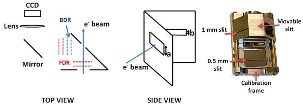
Рисунок 1.15 — Схематическое изображение интерферометрической мишени дифракционного излучения (слева) и фотография мишени (справа). Рисунок взят из работы [119]
