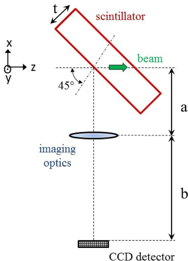
Рисунок 3.4 — Схема получения изображения пучка с использованием сцинтиллятора, вид сверху
