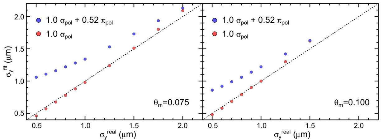
Рисунок 3.19 — Зависимость размера пучка, полученного из аппроксимации ( $\sigma_y^{\text{fit}}$ ), от истинного размера пучка ( $\sigma_y^{\text{real}}$ ) для случая «чистой»  $\sigma$ -компоненты излучения (красные круги) и «смешанной»  $\sigma$ - и  $\pi$ -компоненты излучения (синие круги) для числовых апертур  $\theta_m = 0,075$  и  $\theta_m = 0,100$ . Размеры пучка взяты для идеальной фокусировки (профиль  $x_i/M = 0$ ). Штриховая линия показывает идеальное совпадение
