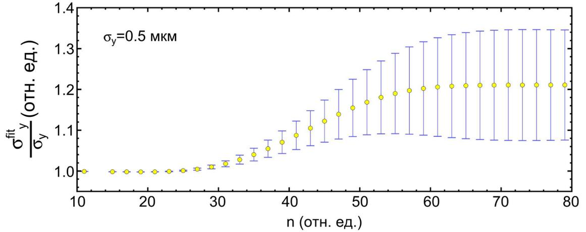
Рисунок 2.13 — Зависимость относительного размера пучка, полученного при аппроксимации функцией (2.17), нормированного на истинный размер пучка, от количества точек в распределении. Истинный размер пучка  $\sigma_y = 0,5$  мкм.
