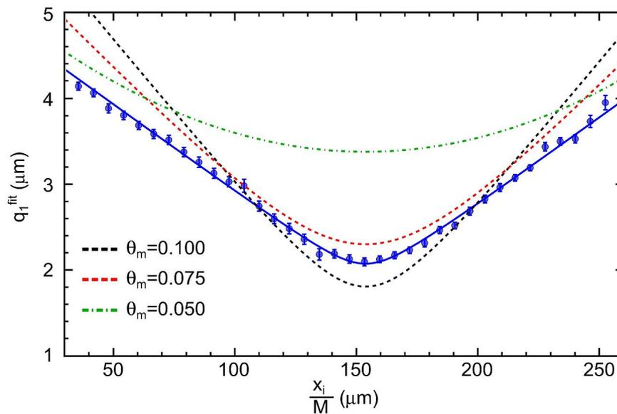
Рисунок 3.26 — Зависимость положения максимума в распределении чистой SPF для различных горизонтальных координат (синие точки), и аппроксимация функцией (3.6) (синяя сплошная линия) - экспериментальные данные. Различные прерывистые линии - теоретически рассчитанные данные для различных значений  $\theta_m$
