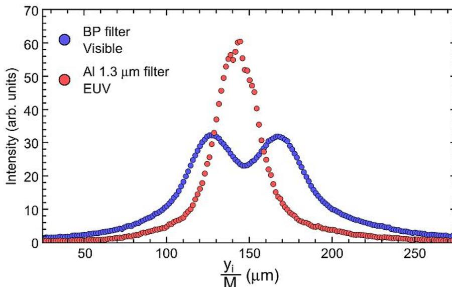
Рисунок 4.17 — Вертикальные проекции изображений пучка конфигурации 2 в разных спектральных диапазонах
