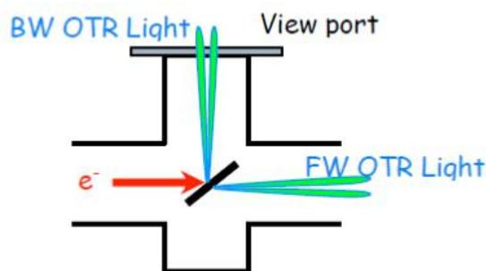
Рисунок 1.10 — Схема генерации переходного излучения вперед (прямое переходное излучение - FW) и назад (обратное переходное излучение - BW). Рисунок взят из работы [100]
