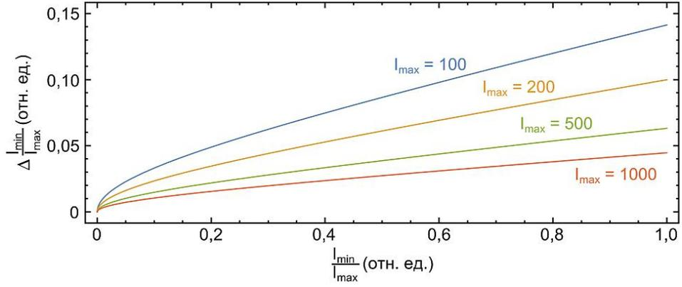
Рисунок 2.23 — Зависимость абсолютной неопределённости величины относительной глубины провала от глубины провала для различных значений  $I_{max}$
