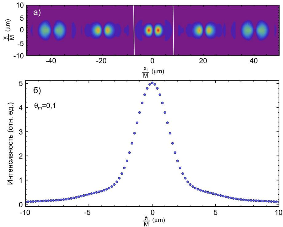
Рисунок 2.30 — Схема получения изображения для  $\pi$ -компоненты поляризации (вверху) и вертикальная проекция центрального SPF (внизу). Белыми полосами отмечены границы получения вертикальной проекции
