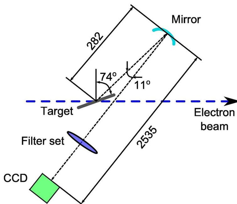
Рисунок 4.9 — Схема проведения эксперимента по визуализации поперечного размера электронного пучка при использовании обратного переходного излучения в спектральных диапазонах видимого света и вакуумного ультрафиолета
