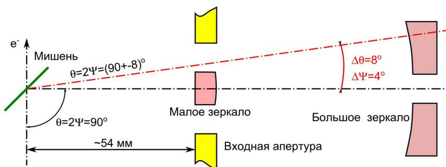
Рисунок 3.23 — Схематическое изображение осевой и внеосевой визуализации поперечного размера пучка объективом Шварцшильда
