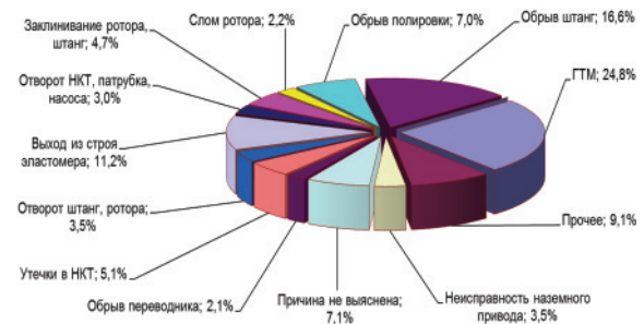
Рис. 1. Распределение отказов УШВН по основным причинам отказа подземного и наземного оборудования
